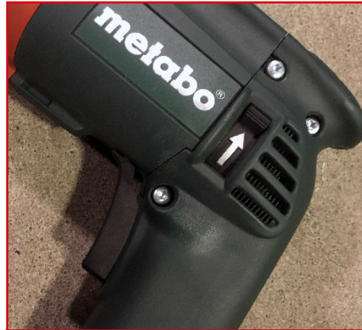
ABBILDUNG 3-10. DER RICHTUNGS-WAHSCHALTER AUF „VORWÄRTS“ EINGESTELLT.
