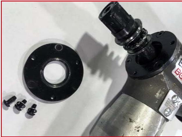
FIGURE 3-4. ÉCHANGE D'ARBRE CENTRAL
