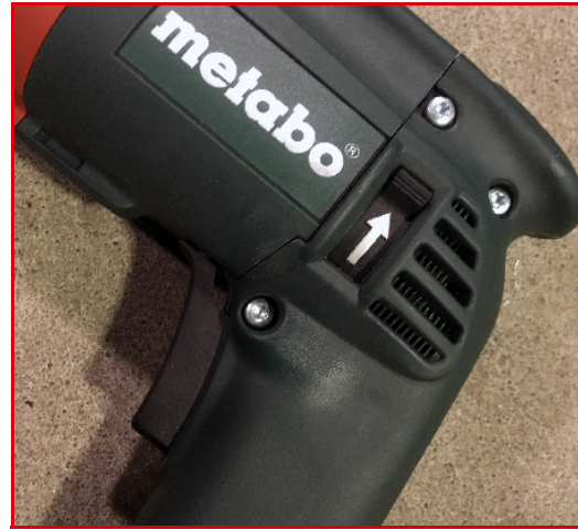
FIGURE 3-10. COMMANDE DE LA DIRECTION DU MOTEUR RÉGLÉE SUR MARCHÉ AVANT
