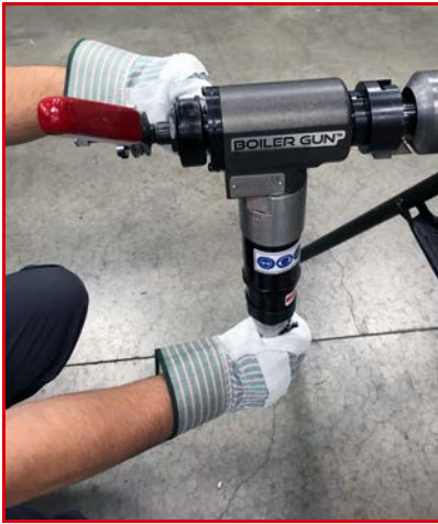
FIGURE 4-1. POSITION DES MAINS PENDANT LE FONCTIONNEMENT DE LA BOILER GUN
