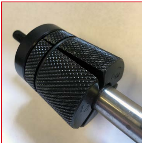
FIGURE 3-3. JEU DE VIROLE MONTÉE
