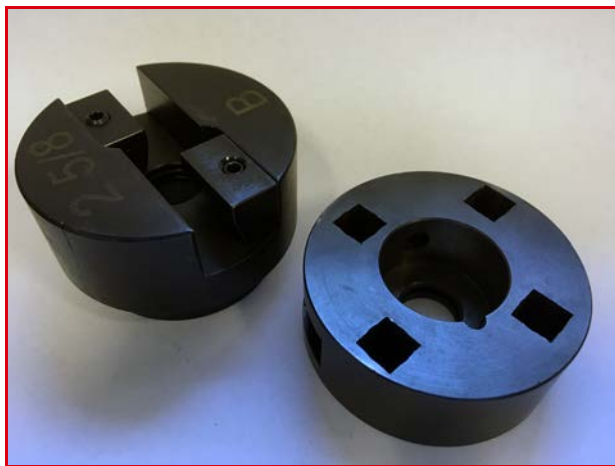
FIGURE 3-7. PORTE-OUTIL COULISSANT (G) ET PORTE-OUTIL FIXE (R)
