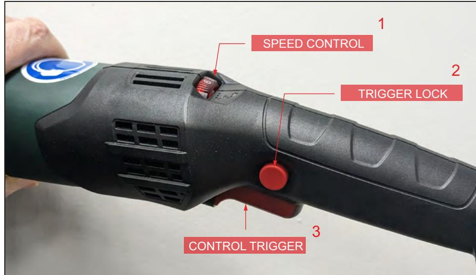
FIGURE 2-3. COMMANDES DU MOTEUR
