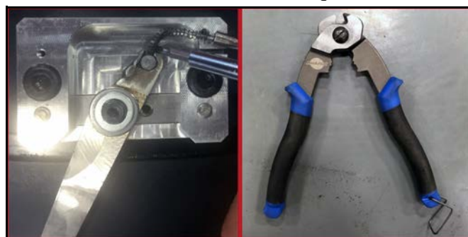
FIGURA 5-8. RETIRADA DEL EXTREMO DEL BARRIL DEL CABLE (IZQUIERDA); CORTADORES DE CABLE Y CARCASA (DERECHA)
