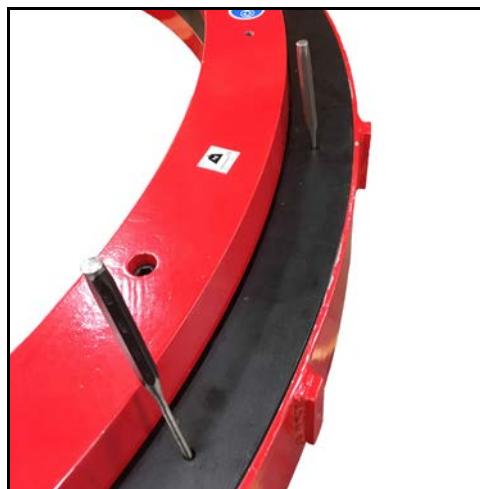
FIGURA 5-3. PUNZONES UTILIZADOS PARA INSTALAR LOS PROTECTORES
