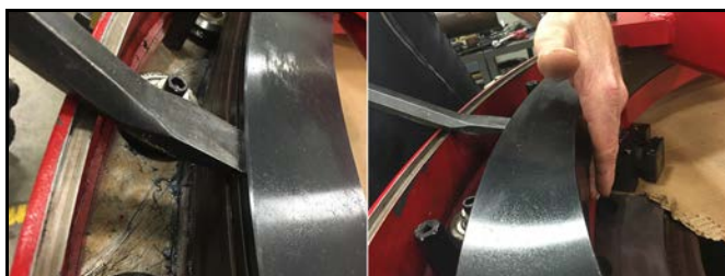
FIGURA 5-6. COMPROBACIÓN DEL RECORRIDO ENTRE EL ANILLO DE RODADURA Y EL ANILLO FIJO
