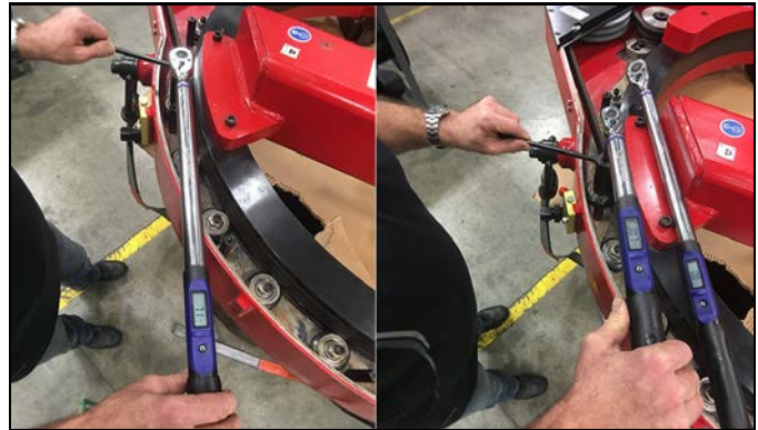
FIGURA 5-5. AJUSTE Y APIRIETE DE LOS BUJES Y LOS TORNILLOS DE LA TAPA
