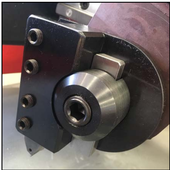
FIGURA 3-11. PORTAHERRAMIENTAS DE DESFASE (N/P 89203)
