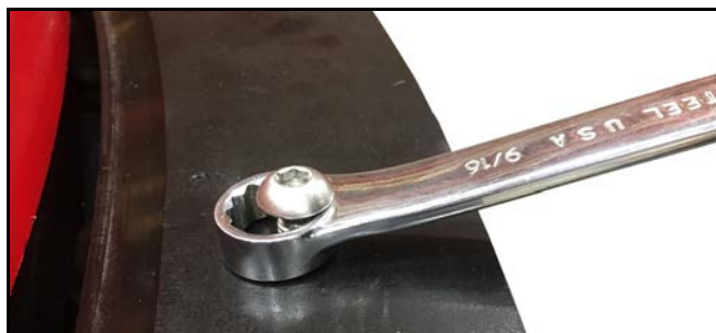
FIGURA 5-2. LLAVE DE ESTRELLA SOBRE EL TORNILLO
