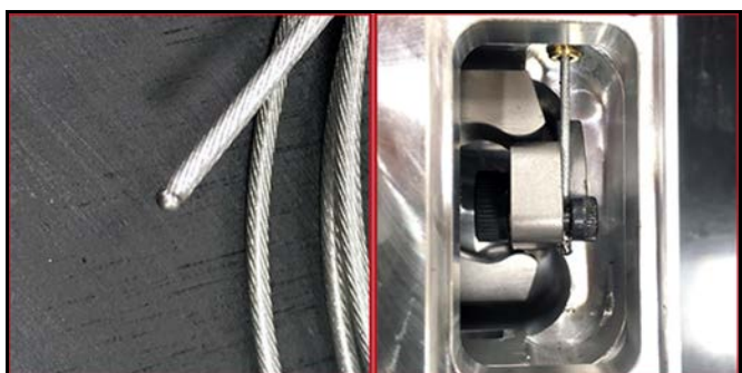
FIGURA 5-11. EXTREMO DEL CABLE TRATADO POR SOLDADURA (IZQUIERDA); EXTREMO DEL CABLE ASEGURADO BAJO EL TORNILLO M4 (DERECHA)
