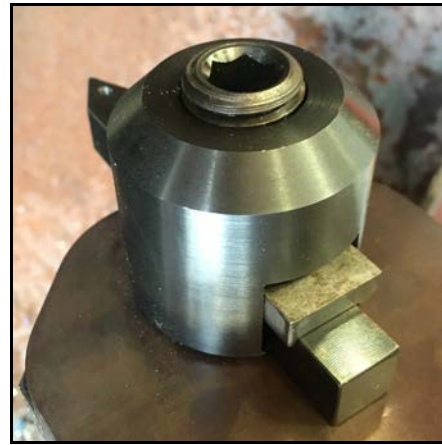
FIGURA 3-10. ADAPTADOR DE HERRAMIENTA DE 12,7 MM (0,5") INSTALADO (N/P 89175)
