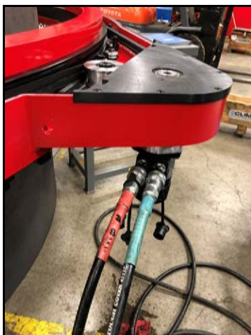
FIGURA 3-15. ACCIONAMIENTO DEL MOTOR HIDRÁULICO INSTALADO (LADO INFERIOR)
