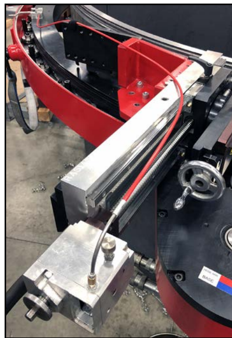
FIGURA 4-5. COMPONENTES DE REFRENTADO POSTERIOR REUBICADOS
