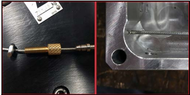
FIGURA 5-10. CODO DE 90°, TUERCA DE AJUSTE Y CONTRATUERCA (IZQUIERDA); EL EXTREMO DEL CABLE SE MUESTRA EN EL LUGAR DE CORTE (DERECHA)
