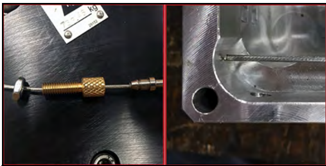
РИСУНОК 5-10. УГОЛОК 90°, РЕГУЛИРОВОЧНАЯ ГАЙКА И КОНТРГАЙКА (СЛЕВА); МЕСТО ОБРЕЗКИ КОНЦА ТРОСА (СПРАВА)
