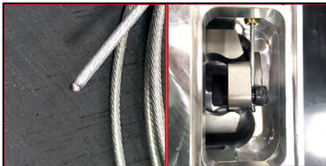
РИСУНОК 5-11. ЗАПАЯННЫЙ КОНЕЦ ТРОСА (СЛЕВА); КОНЕЦ ТРОСА, ЗАКРЕПЛЕННЫЙ ПОД ВИНТОМ М4 (СПРАВА)
