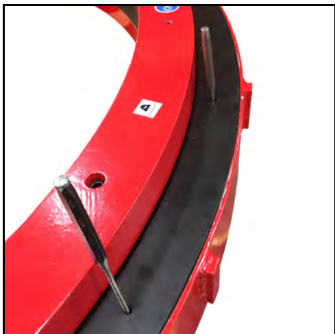
Рисунок 5-3. Пробойники, используемые для установки защиты
