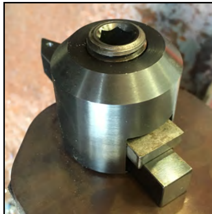
РИСУНОК 3-10. УСТАНОВЛЕННЫЙ ПЕРЕХОДНИК 0,50" (КАТ. № 89175)
