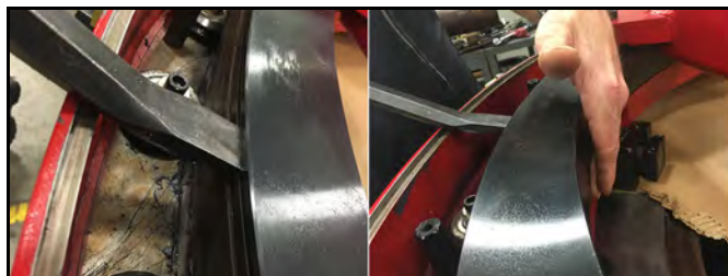
Рисунок 5-6. Проверка люфта между направляющим и стационарным кольцом
