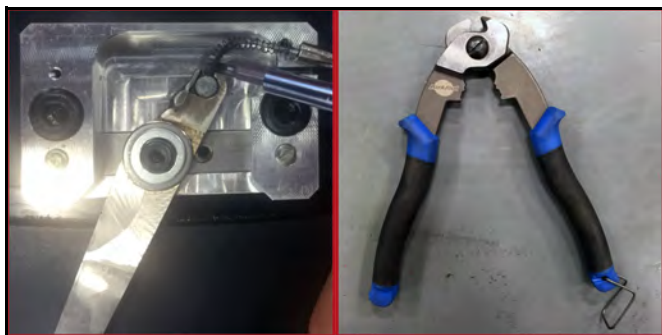
РИСУНОК 5-8. ИЗВЛЕЧЕНИЕ ТРОСА ЗА ЦИЛИНДР НА КОНЦЕ (СЛЕВА); ИНСТРУМЕНТ ДЛЯ ОБРЕЗКИ ТРОСА И КОЖУХА (СПРАВА)
