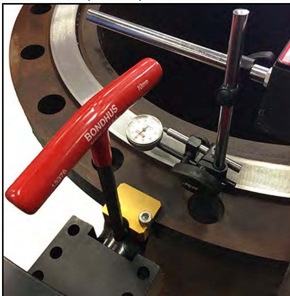
РИСУНОК 3-8. Циферблатный индикатор, установленный для выравнивания
