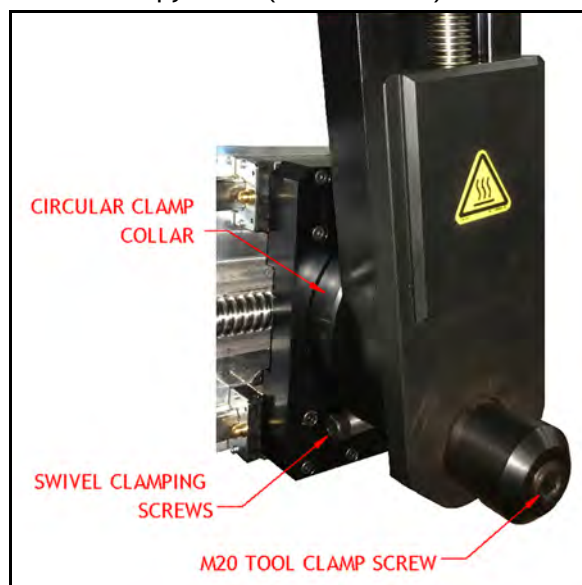
РИСУНОК 3-9. МЕСТОНАХОЖДЕНИЕ ВИНТА ФИКСАЦИИ НАКЛОНА
