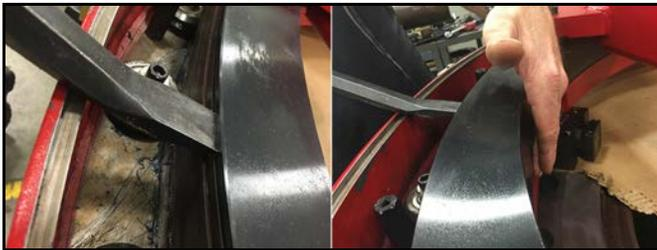
ABBILDUNG 5-6. ÜBERPRÜFUNG DES SPIELS ZWISCHEN DEM LAUFRING UND DEM FESTSTEHENDEN RING
