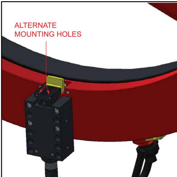
ABBILDUNG 3-4. ALTERNATIVE MONTAGEBOHRUNGEN
