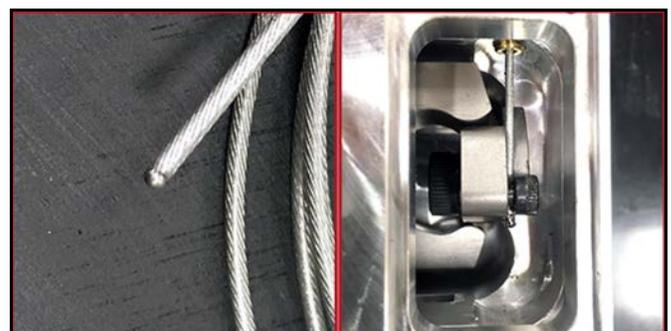
ABBILDUNG 5-11. GELÖTETES KABELLENDE (LINKS); KABELLENDE UNTER DER M4-SCHRAUBE BEFESTIGT (RECHTS)
