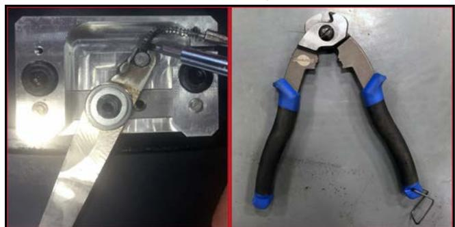
ABBILDUNG 5-8. TROMMELENDE DER KABELNÄHME (LINKS); KABEL- UND GEHÄUSESCHNEIDER (RECHTS)
