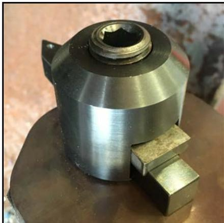
ABBILDUNG 3-10. INSTALLIERTER 0,50"-WERKZEUGADAPTER (P/N 89175)
