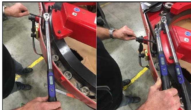
ABBILDUNG 5-5. EINSTELLEN UND ANZIEHEN DER BUCHSEN UND KOPFSCHRAUBEN
