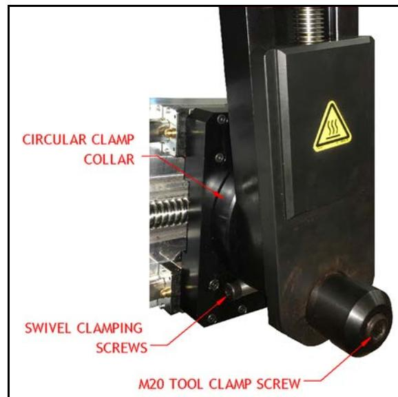
ABBILDUNG 3-9. LAGE DER SCHWENK-KLEMMSCHRAUBE
