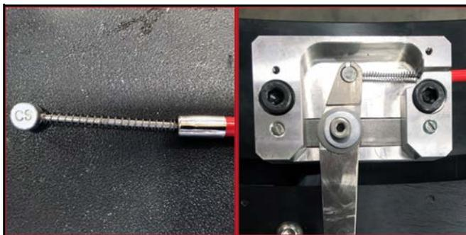
ABBILDUNG 5-9. TROMMELENDE DES KABELS MIT FEDER, ADERENDHÜLSE, AM KABELGEHÄUSE INSTALLIERT (LINKS); KABEL IM STELLGLIEDGEHÄUSE INSTALLIERT (RECHTS)
