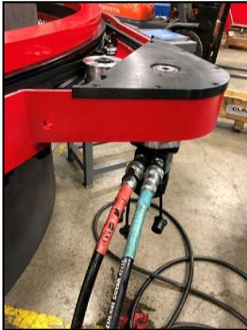
ABBILDUNG 3-15. INSTALLIERTER HYDRAULIKMOTORANTRIEB
