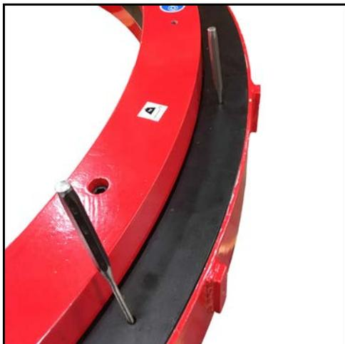
ABBILDUNG 5-3. STEMPEL FÜR DIE INSTALLATION DES SCHUTZES
