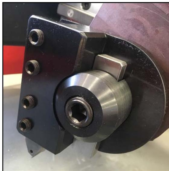
ABBILDUNG 3-11. VERSETZTER WERKZEUGHALTER (P/N 89203)
