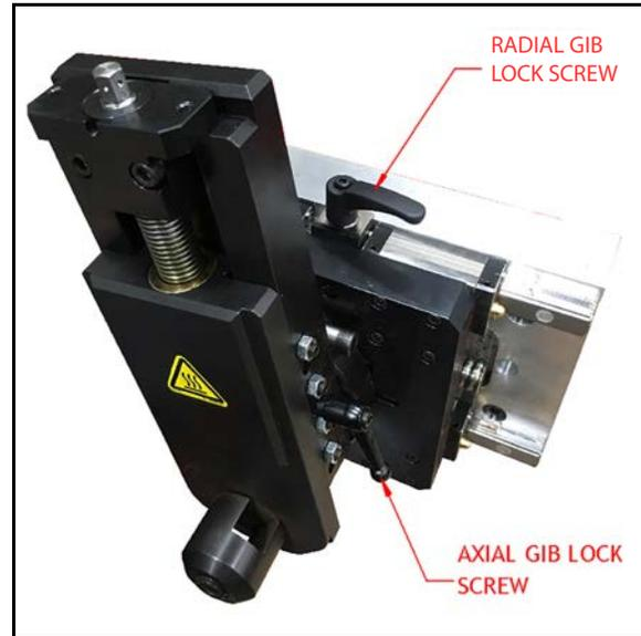
ABBILDUNG 4-2. FÜHRUNGSSICHERUNGSSCHRAUBEN
