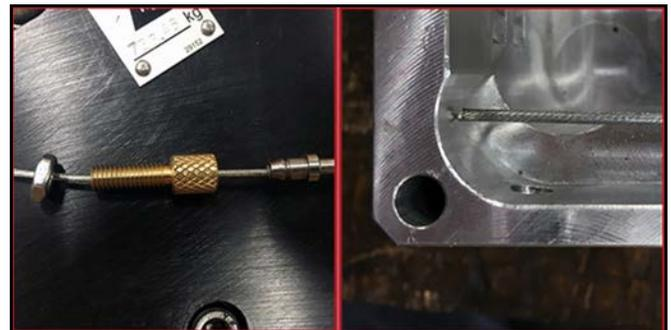
ABBILDUNG 5-10. 90°-ELLBOGEN, EINSTELLMUTTER UND KONTERMUTTER (LINKS); KABELLENDE AN DER TRIMMSTELLE DARGESTELLT (RECHTS)
