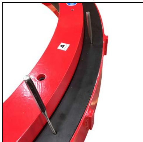
FIGURE 5-3. POINÇONS UTILISÉS POUR L'INSTALLATION DE LA PROTECTION
