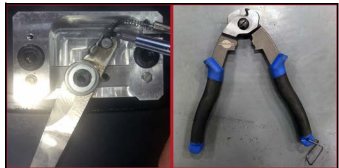
FIGURE 5-8. RETRAIT DE L'EXTRÉMITÉ CYLINDRIQUE DU CÂBLE (GAUCHE) ; COUPE-CÂBLES ET GAINES (DROITE)
