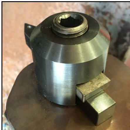
FIGURE 3-10. ADAPTATEUR POUR OUTIL DE 0,50" INSTALLÉ (RÉF. 89175)
