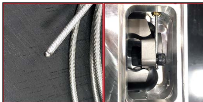
FIGURE 5-11. EXTRÉMITÉ DE CÂBLE SOUDÉE (GAUCHE) ; EXTRÉMITÉ DE CÂBLE FIXÉE SOUS LA VIS M4 (DROITE)
