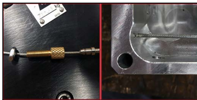
FIGURE 5-10. COUDE À 90°, ÉCROU DE RÉGLAGE ET CONTRE-ÉCROU (GAUCHE) ; EXTRÉMITÉ DE CÂBLE ILLUSTRÉE À L'EMPLACEMENT DE LA COUPE (DROITE)
