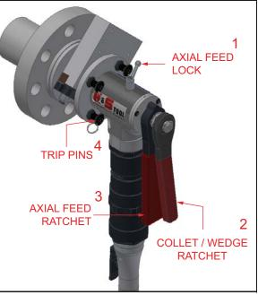
FIGURE 4-3. AXIAL FEED LOCK AND RATCHET
