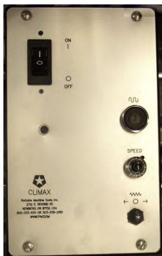
Рис. 4. Подвесной пульт управления коробкой подач
