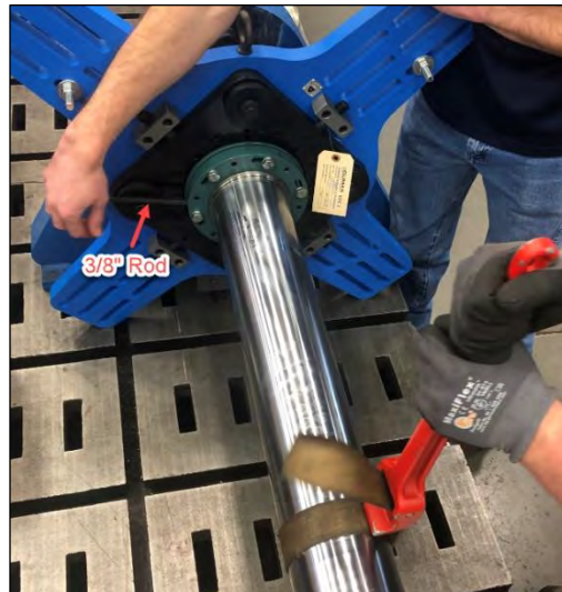
Рис. 14. Вставка штанги 3/8 дюйма
