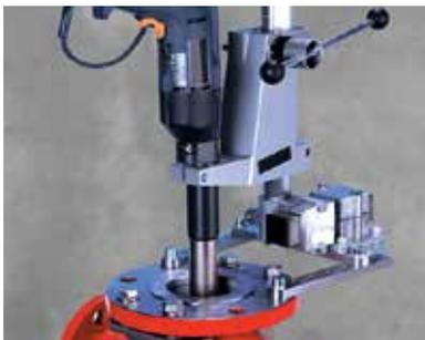
Esmerilado de asientos de válvula de globo y reparación de válvulas de seguridad VM2000
