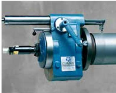
Robusto, fiable, preciso y potente, a . Diseñado para diámetros de eje de 4 a 11,25 pulgadas (101,6 a 285,8 mm).
