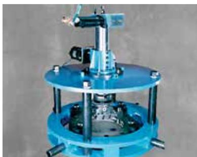
Reparación de válvulas de globo, seguridad y control VM6000
