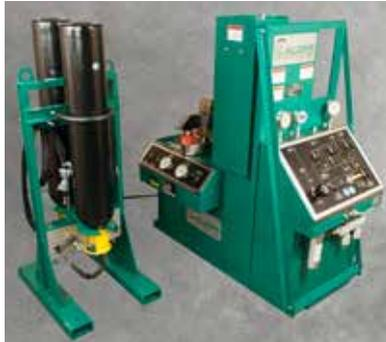
**Comprobador de válvulas de seguridad SRV**
