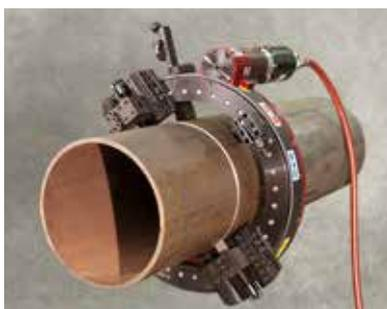
Máquina de bastidor dividido AFC
