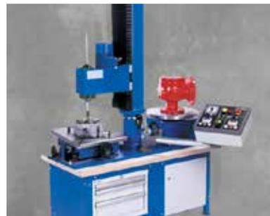
Reparación de compuertas estacionarias y válvulas de globo VM5800
