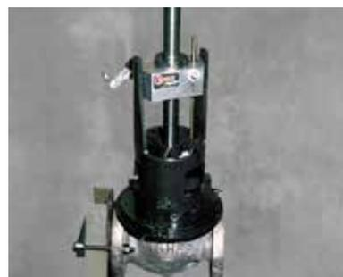
Reparación de válvulas de globo y control VM8000
