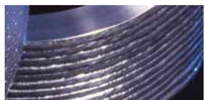
Soldadura automática de diámetro exterior
