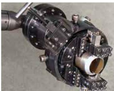
Máquina de bastidor dividido MFC
