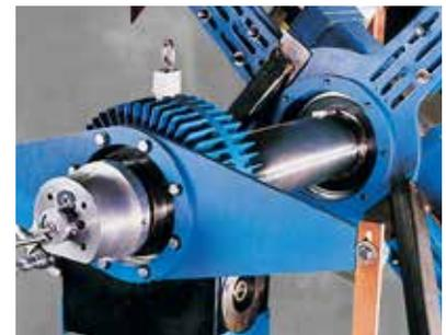
Aléreuse à barre fixe et tête d'usinage mobile **BB8100**
