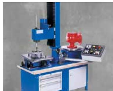
Réparation des robinets-vannes et robinets à soupape fixes **VM5800**
