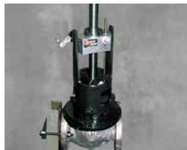
Réparation de robinets à soupape et de vannes de contrôle **VM8000**
