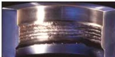
Soudure pour rechargement d'alésages en bronze d'aluminium
