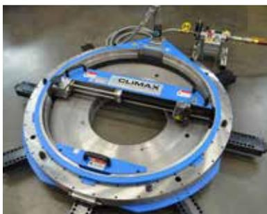
Surfaceuse de brides avec montage sur diamètre extérieur **FF3600**
