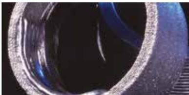
Soudage pour rechargement d'alésages, soudure avec cordon total ou partiel
