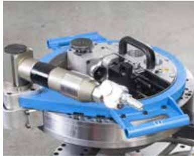
Surfaceuse de brides avec montage sur diamètre extérieur **FF1200**
