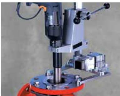
Meulage des sièges de robinets à soupape et réparation de soupapes de sécurité **VM2000**
