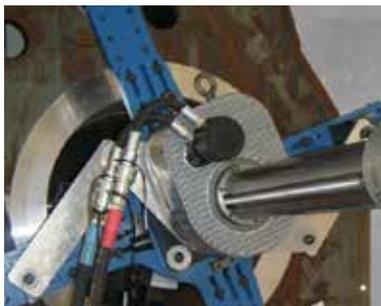
Aléreuse à barre fixe et tête d'usinage mobile **BB7100**
