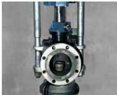
VM7000 Bearbeitung von Sicherheitsventilen
