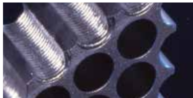
Schweißen in kleinen Bohrungen
