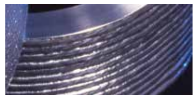
Autom. Schweißen am Außendurchmesser
