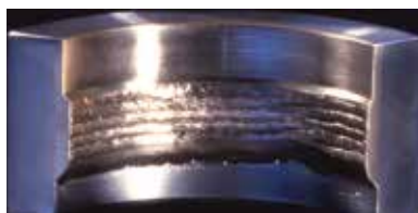
Schweißen in Aluminium-Bronze-Bohrungen
