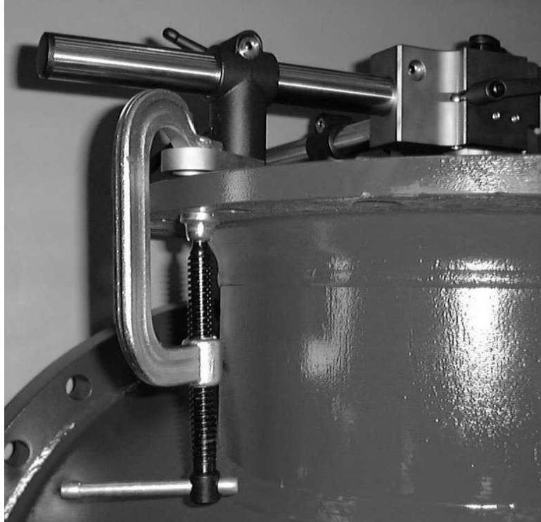
Фото 4.3.2.1: Установка зажимных колодок при помощи струбцин из кованной стали
