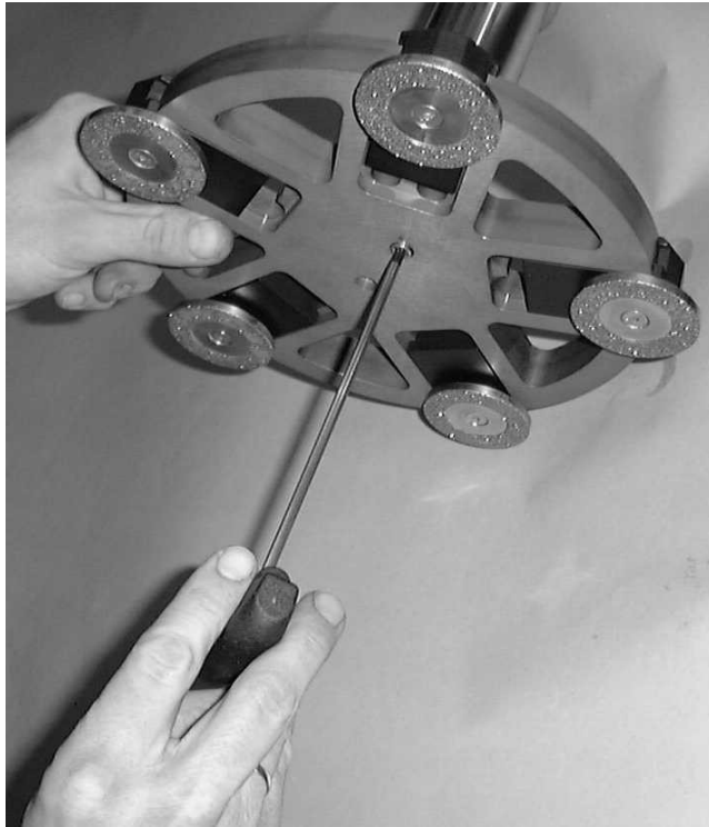
Фото 4.4.2.2: Подгонка планетарного колеса под муфту шарового соединения
