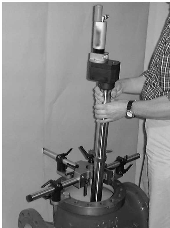
Фото 4.4.3.1: Стыковка станка с универсальным зажимным устройством
