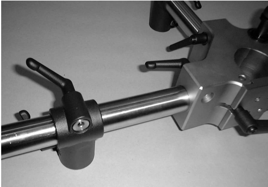
Фото 4.2.0.3: Установка коленчатых зажимов на опорные трубки
