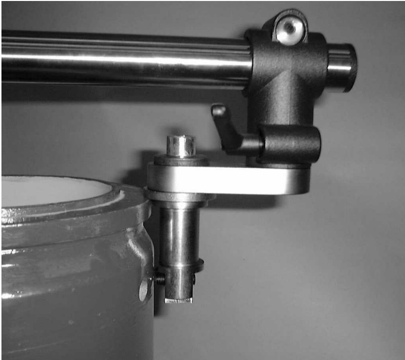
Фото 4.3.3.1: Установка универсального зажимного устройства на корпус клапана без фланца при помощи валиков приспособления "стойка воротника" (приспособление не показано)
