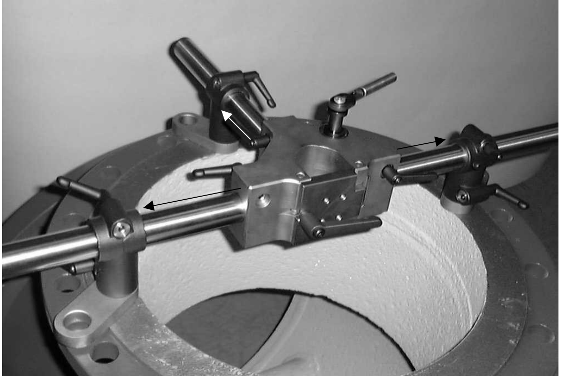
Фото 4.2.0.5: Выравнивание универсального зажимного устройства
