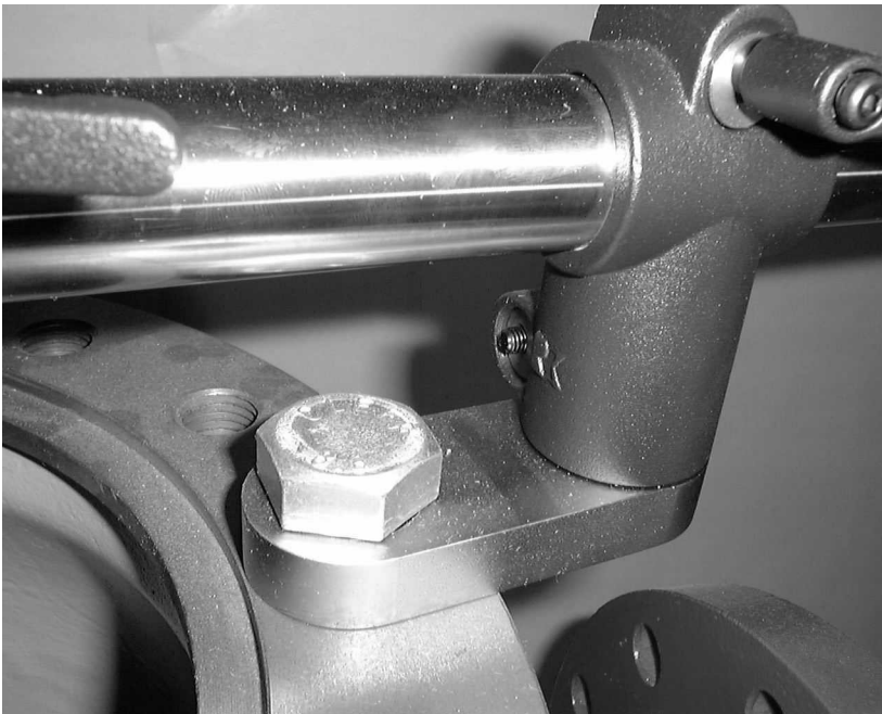
Фото 4.3.1.1: Установка зажимных колодок при помощи болтов
