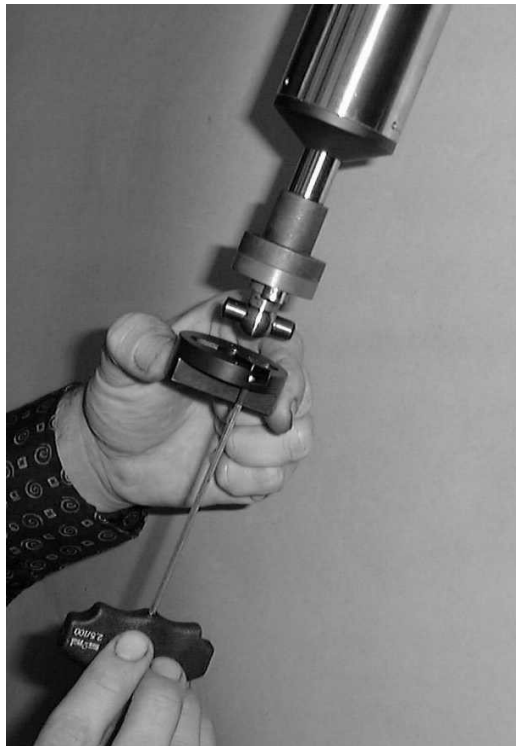
Фото 4.4.2.1: Установка муфты шарового соединения на шпиндель станка
