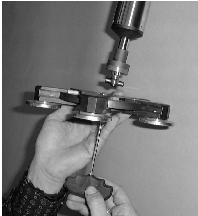
Фото 4.4.1.1: Подгонка планетарного колеса диаметром 100 мм или 135 мм
