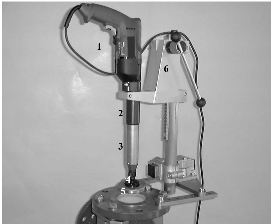
Фото 1.2.1.3: Вид станка с электрическим приводом, установленного на монтажной стойке
