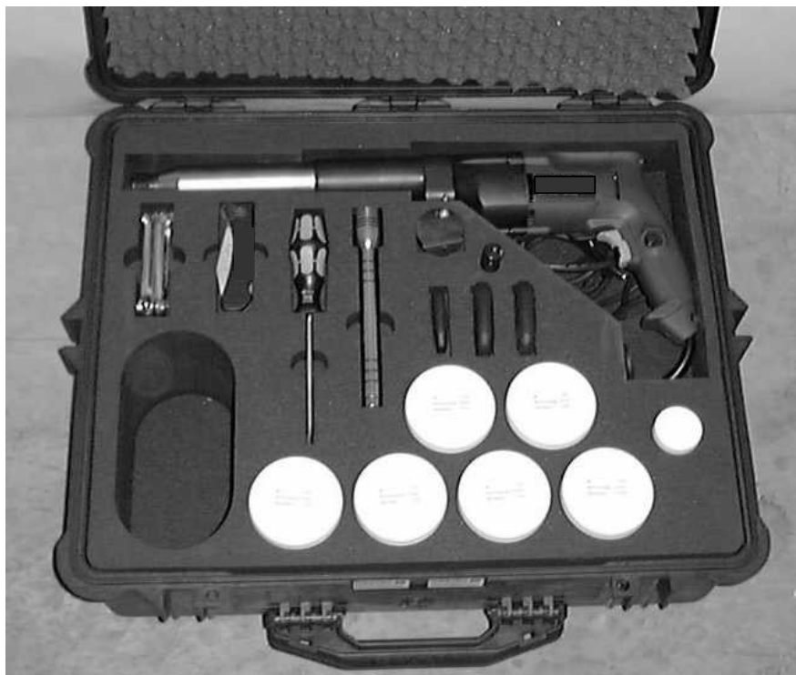
Фото 3.0.0.7: Вид контейнера станка VM2150SV с электроприводом
