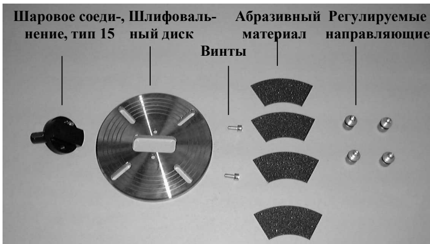
Фото 4.1.1.5: Компоненты инструмента для работы в режиме "ручного станка" с шаровым соединением типа 15 (твердые шлифовальные диски с регулируемыми направляющими)
