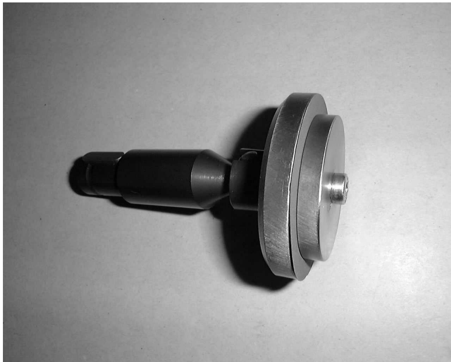
Фото 4.1.2.1: Полностью собранный инструмент для работы в режиме "ручного станка"
