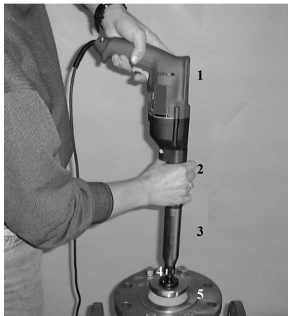
Фото 1.2.1.1: Вид станка с электроприводом, работа в режиме “ручного станка”
