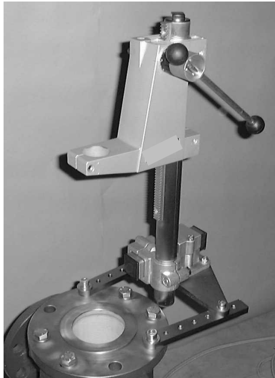
Фото 4.2.1.4: Полностью установленная монтажная стойка
