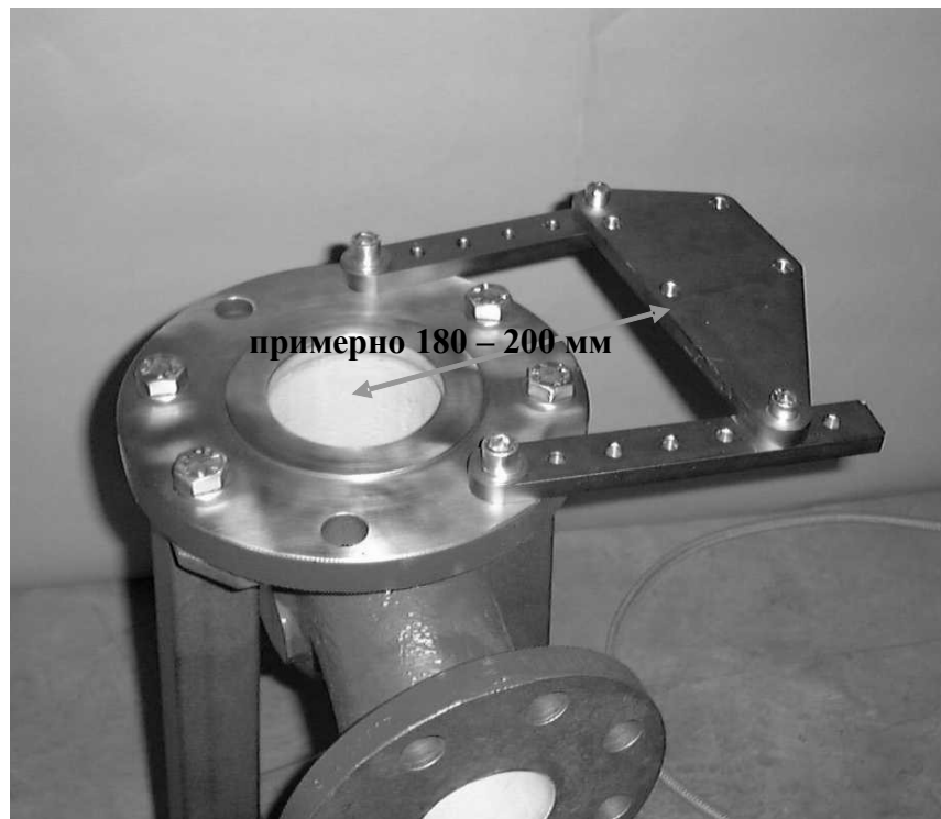
Фото 4.2.1.1: Кронштейны с пластиной основания, установленные на корпус клапана (монтаж на фланце)
