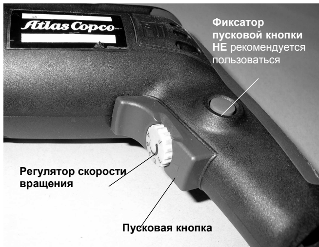
Фото 4.1.4.5: Электропривод (производитель Atlas Copco) с пусковой кнопкой и переключателем направления вращения
