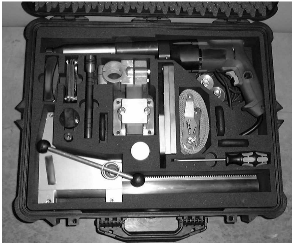
Фото 3.0.0.1: Вид контейнера станка VM2150 с электроприводом
