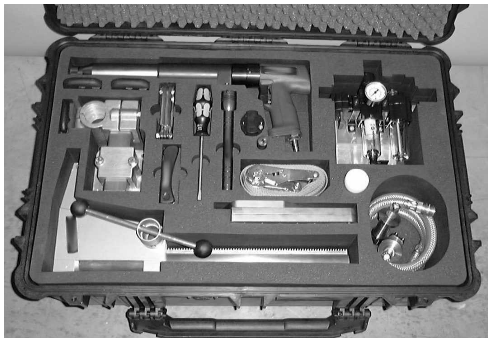
Фото 3.0.0.2: Вид контейнера станка VM2150 с пневматическим приводом
