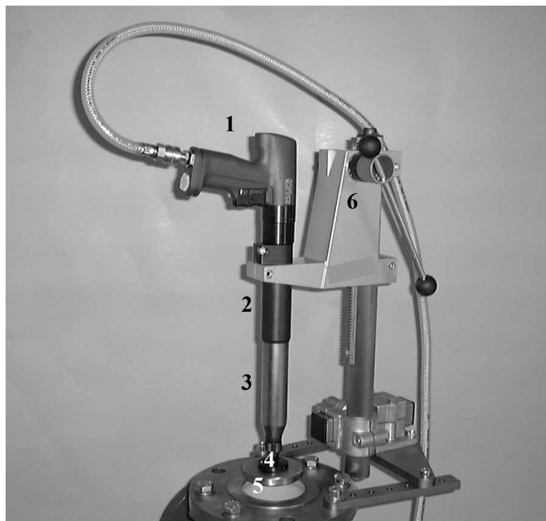
Фото 1.2.1.4: Вид станка с пневматическим приводом, установленного на монтажной стойке
