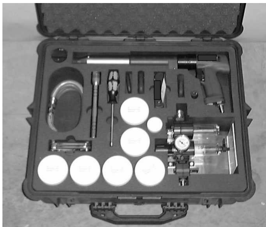
Фото 3.0.0.8: Вид контейнера станка VM2150SV с пневматическим приводом
