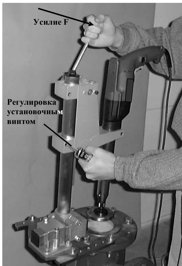
Фото 4.2.3.1: Регулировка вертикальных направляющих на стойке
