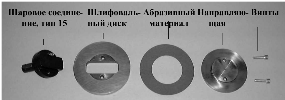
Фото 4.1.1.4: Компоненты инструмента для работы в режиме "ручного станка" с шаровым соединением типа 15 (твердые шлифовальные диски с направляющими)
