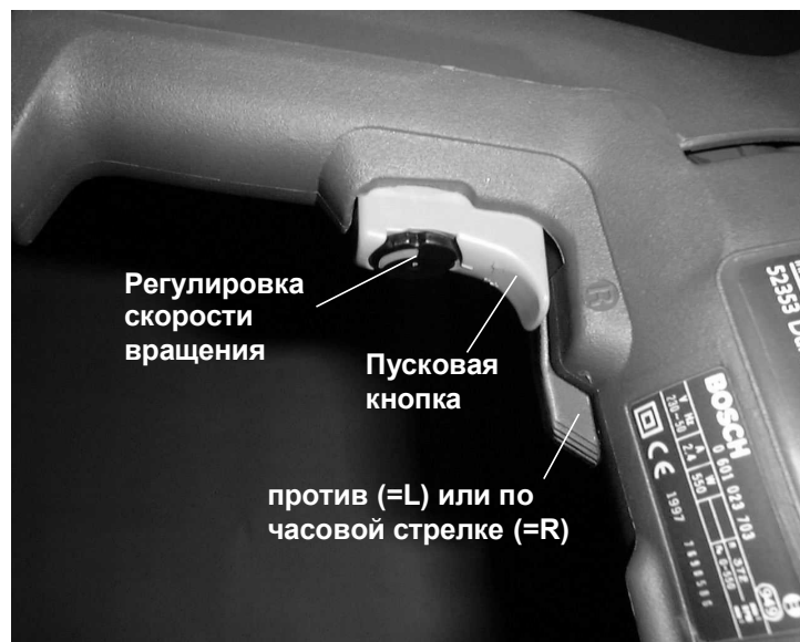
Фото 4.1.4.4: Электропривод (производитель Bosch) с пусковой кнопкой и переключателем направления вращения
