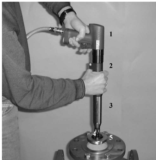
Фото 1.2.1.2: Вид станка с пневматическим приводом, работа в “режиме ручного станка”
