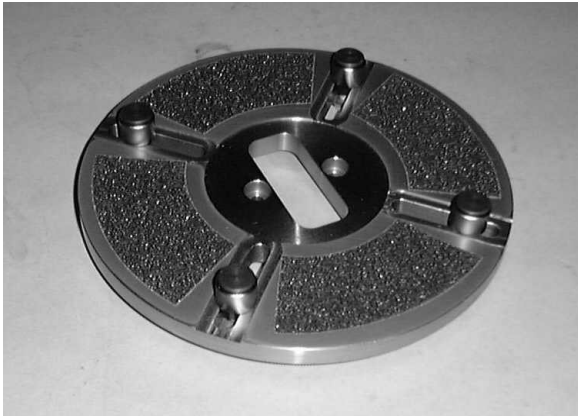
Фото 4.4.0.3: Твердый шлифовальный диск с регулируемыми направляющими для шлифовки плунжеров клапана (согласно внешнему диаметру)
