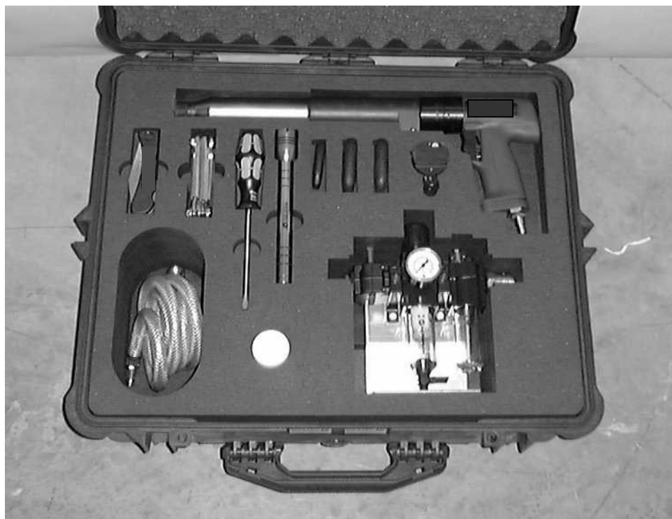
Фото 3.0.0.5: Вид контейнера станка VM2150S с пневматическим приводом
