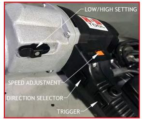
FIGURE 2-3. SPEED DIAL AND TRIGGER CONTROLS
