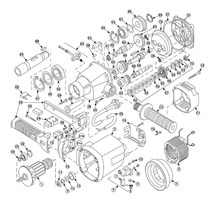
FIGURE A-6. ELECTRIC MOTOR ASSEMBLY (P/N EMT260510)
