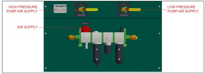
FIGURE 2-3. LOWER CONSOLE CONTROLS
