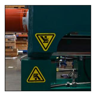
FIGURE 1-3. REAR CLAMP BOX AND FRAME LABEL LOCATIONS
