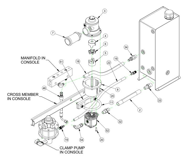
FIGURE A-9. USV-16-200T HYDRAULIC TANK ASSEMBLY (P/N 91593)
