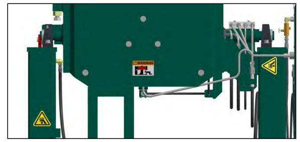
FIGURE 1-2. CLAMP BOX LEFT LABEL LOCATION
