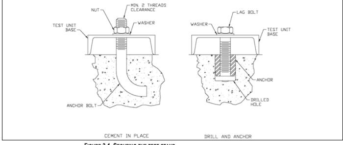
FIGURE 3-1. SECURING THE TEST STAND
