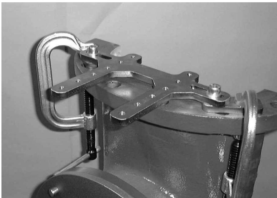
*Фото 4.2.1.3: Установка опорной пластины на фланец с помощью струбцин из кованной стали*
