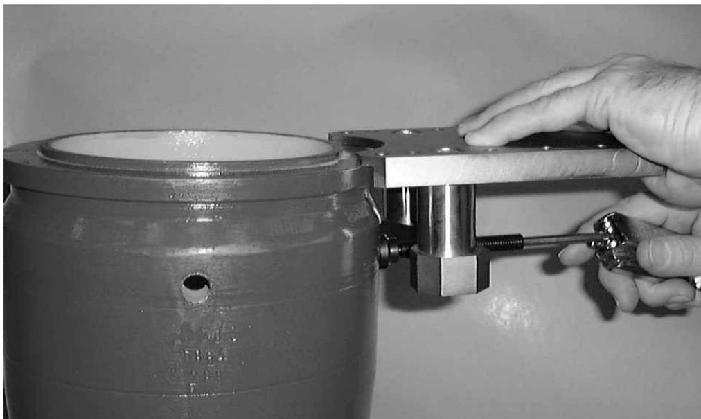
*Фото 4.2.2.2: Регулировка монтажной пластины ленточного хомута*
