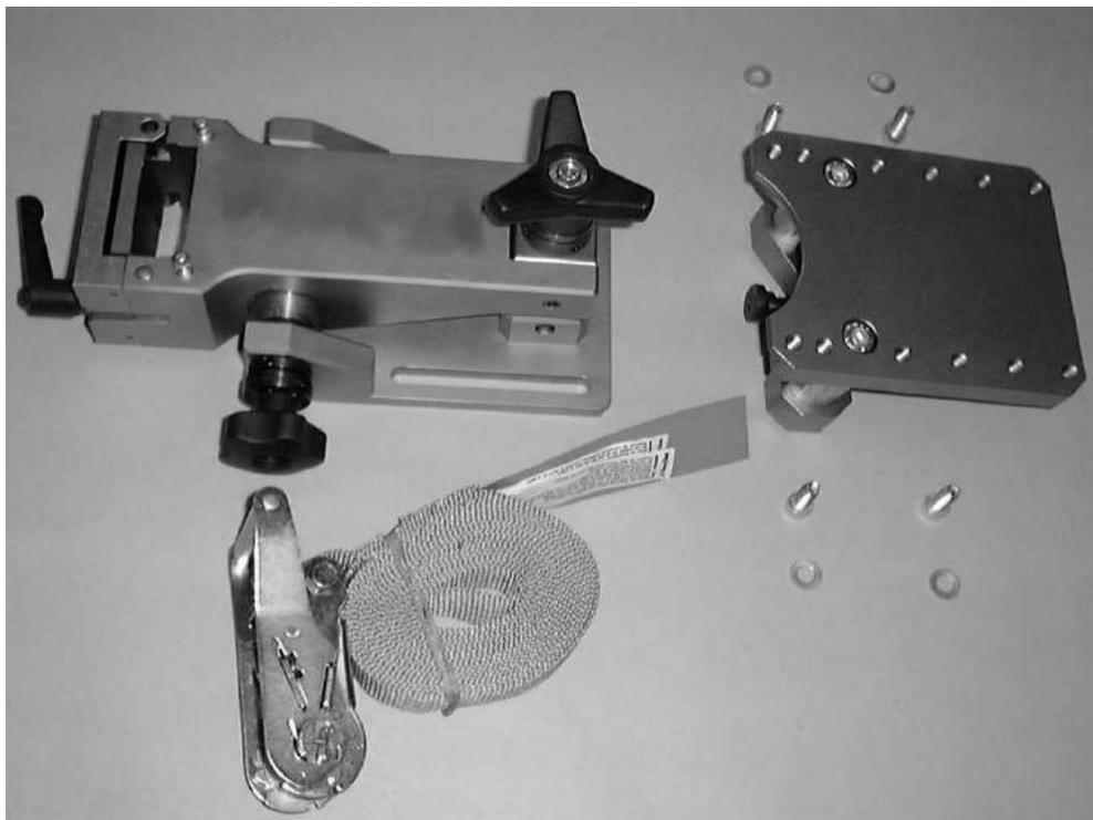
**Фото 4.2.2.1: Компоненты для монтажа ленточного хомута**
