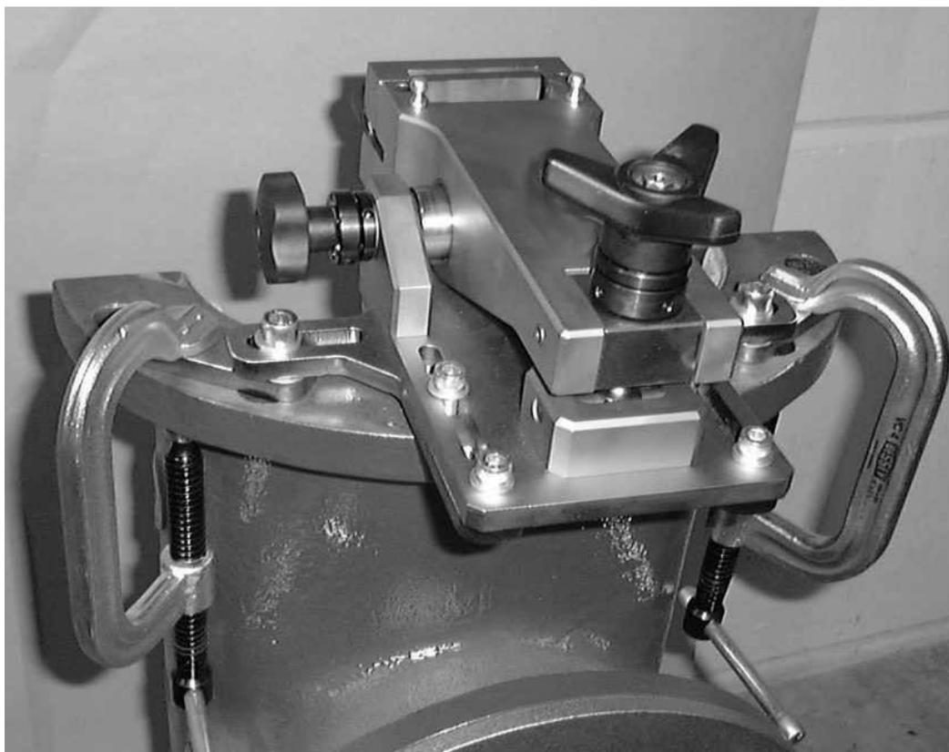
*Фото 4.2.1.4: Адаптер регулировки наклона и опорная пластина, смонтированные на корпусе клапана*
