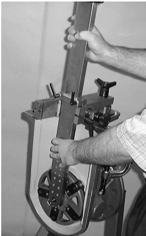
*Фото 4.4.0.1: Размещение рабочего органа станка в адаптере регулировки наклона*
