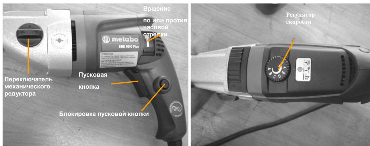
**Фото 4.5.0.3: Кнопки управления электроприводом**
