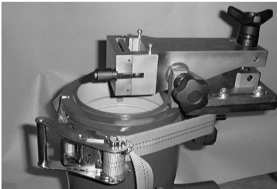
*Фото 4.2.2.6: Адаптер регулировки наклона на монтажной пластине ленточного хомута*
