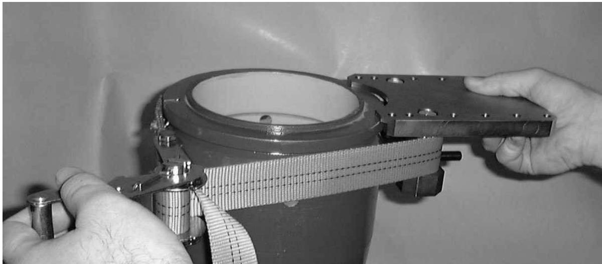
**Фото 4.2.2.3: Размещение ленточного хомута и монтажной пластины**
