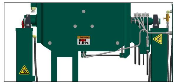
FIGURE 1-2. CLAMP BOX LEFT LABEL LOCATION
