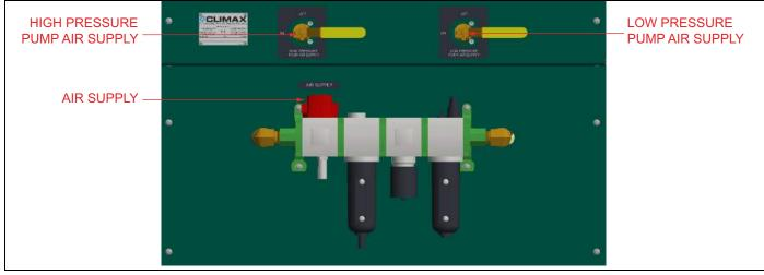
FIGURE 2-3. LOWER CONSOLE CONTROLS
