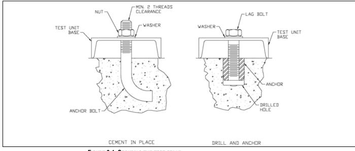
FIGURE 3-1. SECURING THE TEST STAND
