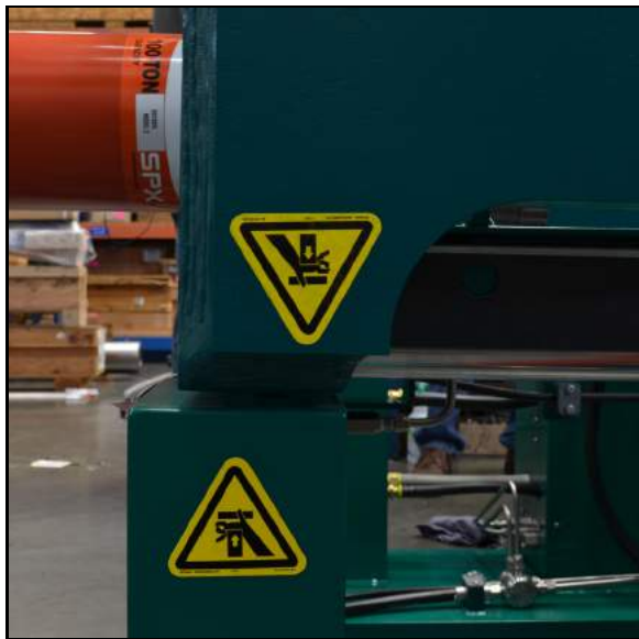
ABBILDUNG 1-3. KENNZEICHNUNG AN DER HINTEREN SEITE DES EINSPANNKASTENS
