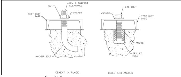
FIGURE 3-1. SECURING THE TEST STAND
