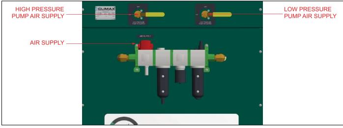
FIGURE 2-3. LOWER CONSOLE CONTROLS
