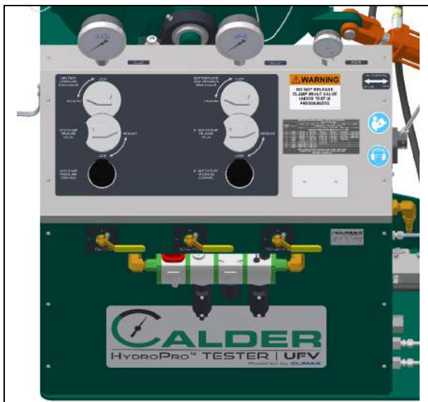
ABBILDUNG 1-1. PLATZIERUNG DER KENNZEICHEN AN DER KONSOLE
