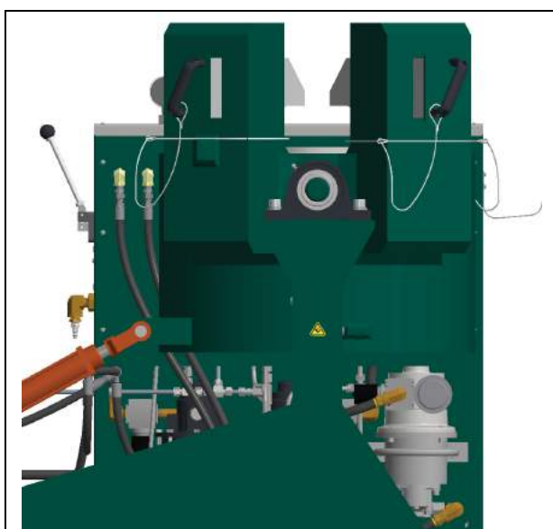
ABBILDUNG 1-3. PLATZIERUNG DER KENNZEICHEN AN DER RÜCKSEITE DER EINSpanN-TROMMEL
