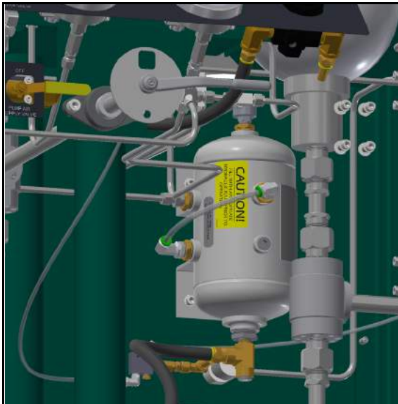
Рисунок 1-5. МЕСТОПОЛОЖЕНИЕ ТАБЛИЧКИ ГИДРОБАКА (НЕ ВИДНА В СОБРАННОМ СОСТОЯНИИ)
