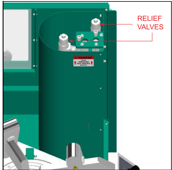
FIGURE 4-1. PUNTOS DE DESFOGUE DE LA VÁLVULA DE ALIVIO
