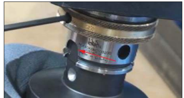
FIGURA 47 MUESCA PROFUNDA EN UN LADO DEL CABEZAL PORTAHERRAMIENTAS
