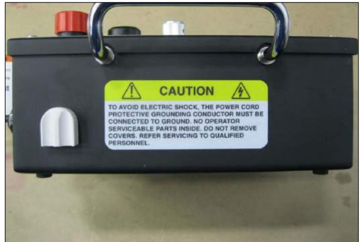
FIGURA 16 UBICACIONES ETIQUETAS EN EL LADO DERECHO DEL CONTROLADOR 120V/230V DEL HUSO HSK
