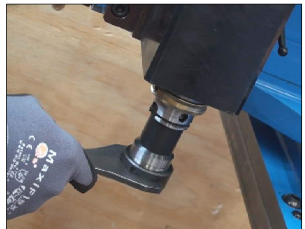
FIGURA 48 INSTALACIÓN DE LA PINZA DE MOLINO DE EXTREMO HSK
