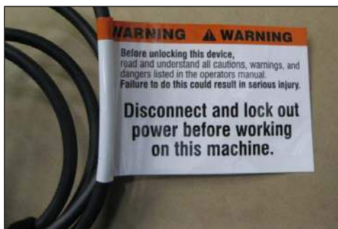
FIGURA 18 UBICACIONES ETIQUETAS DEL CABLE ELÉCTRICO (FRONTAL)
