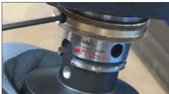
Рис. 47. ГЛУБОКИЙ ПАЗ НА ОДНОЙ СТОРОНЕ ИНСТРУМЕНТАЛЬНОЙ ГОЛОВКИ
