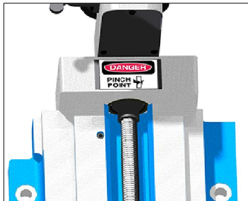
**РИС. 8. РАСПОЛОЖЕНИЕ ЭТИКЕТОК НА ПРИВОДЕ ПОДАЧИ**
