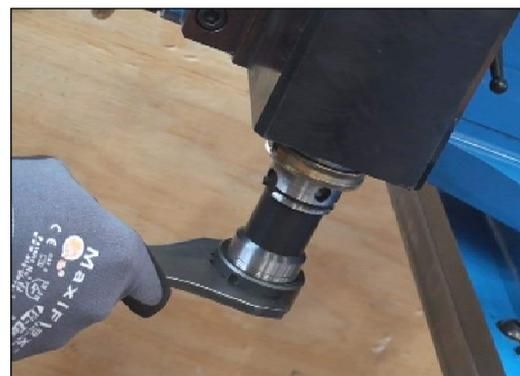
Рис. 48. УСТАНОВКА ЗАЖИМНОЙ ВТУЛКИ КОНЦЕВОЙ ФРЕЗЫ HSK
