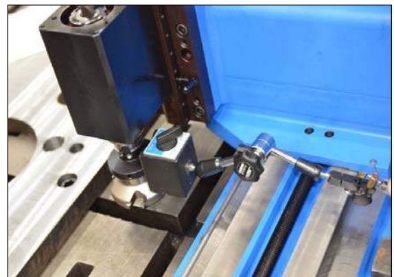
ABBILDUNG 49 AM FRÄSKOPF BEFESTIGTE MESSUHR
