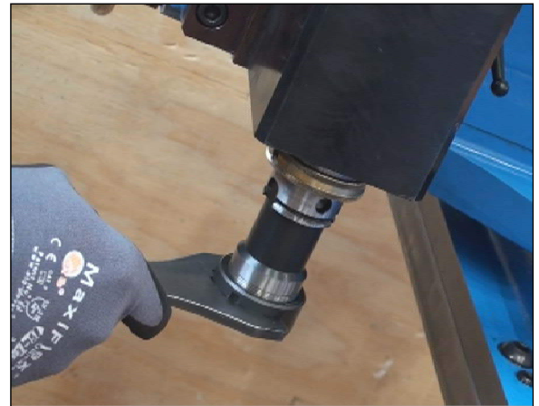
ABBILDUNG 48 INSTALLATION DER HSK-FRÄSKOPF-SPANNZANGE
