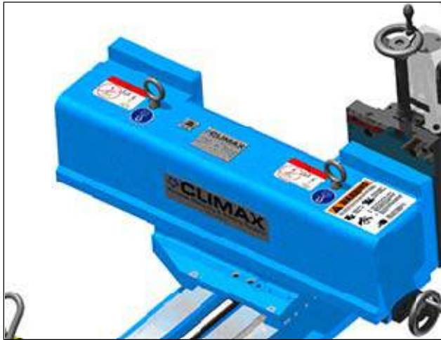
ABBILDUNG 9 POSITIONEN DER KENNZEICHNUNGEN QUERBALKEN
