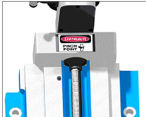
ABBILDUNG 8 POSITIONEN DER KENNZEICHNUNGEN VORSCHUBANTRIEB
