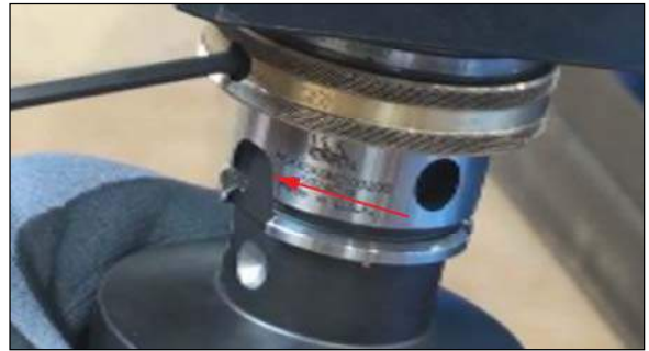
ABBILDUNG 47 TIEFE KERBE AUF EINER SEITE DES FRÄSKOPFES
