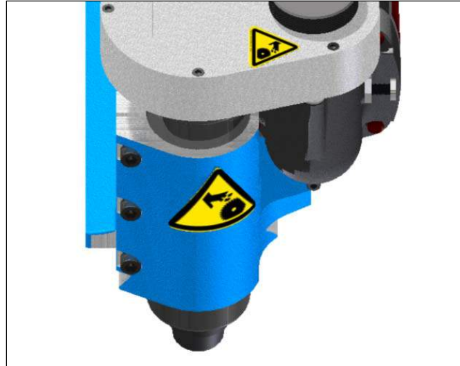
ABBILDUNG 2 POSITIONEN DER KENNZEICHNUNGEN AN DER WELDON-SPINDEL
