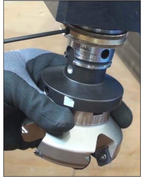
ABBILDUNG 46 AUSBAU DES FRÄSERS MIT INBUSSCHLÜSSEL
