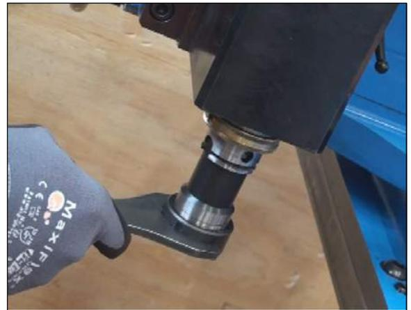
FIGURE 48 INSTALLATION DE LA VIROLE D'EXTREMITÉ HSK DE LA FRAISEUSE
