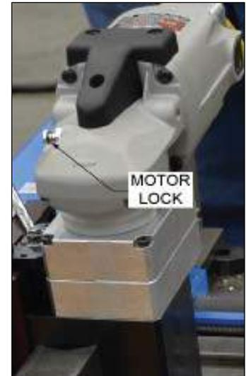
**FIGURE 43 VERROU DE MOTEUR ELECTRIQUE**
