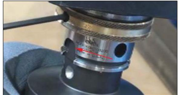
FIGURE 47 ENCOCHE PROFONDE D'UN CÔTÉ DE LA TÊTE D'OUTIL
