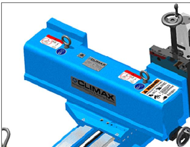
**FIGURE 9 EMPLACEMENT DES ÉTIQUETTES SUR LE LARDON**
