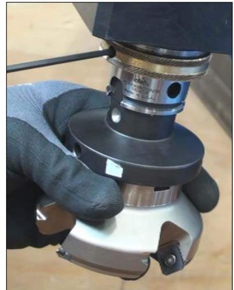
**FIGURE 46 RETIRER LES OUTILS AVEC UNE CLE BTR**
