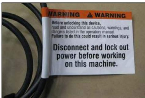
**FIGURE 18 EMBLACEMENT DES ÉTIQUETTES SUR LE CÂBLE ÉLECTRIQUE (AVANT)**
