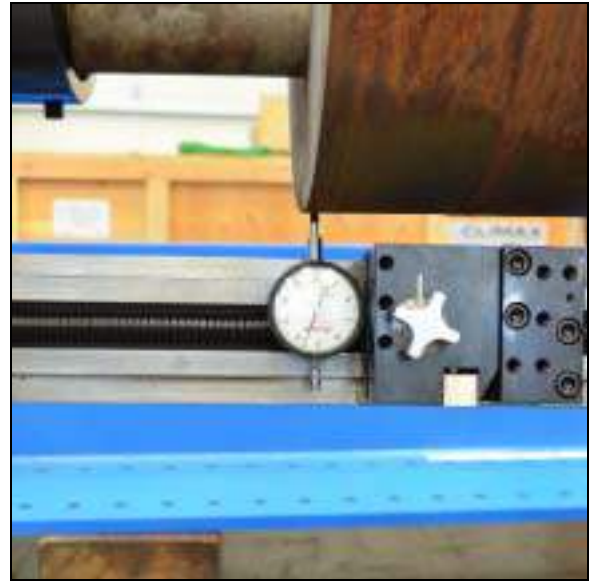
FIGURA 7. COLOCACIÓN DE UN INDICADOR PARA CENTRAR LA MÁQUINA
