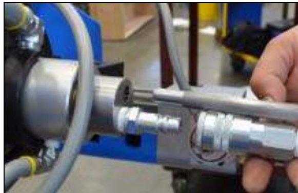
FIGURA 12. CONEXIÓN DE LAS MANGUERAS DE AIRE
