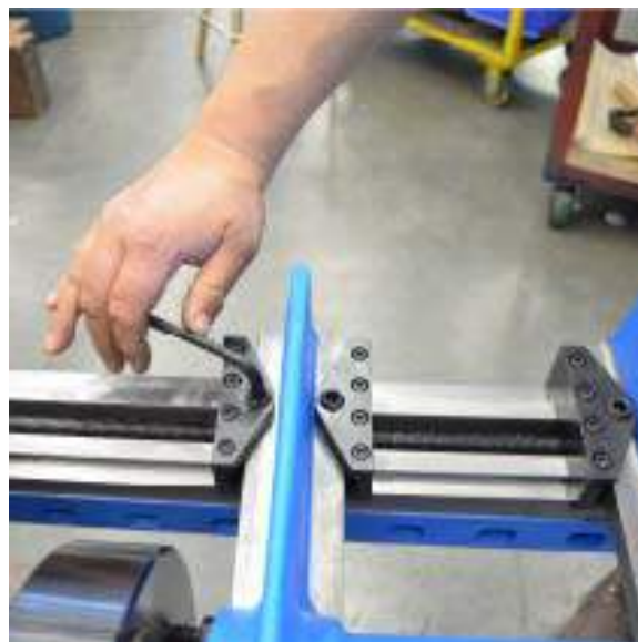
FIGURA 9. UBICACIÓN DE LOS PERNOS DE ANCLAJE DE LA BARRA GIRATORIA
