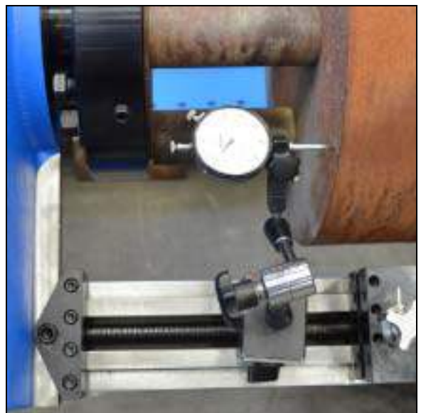
FIGURA 8. COLOCACIÓN DE UN INDICADOR PARA NIVELAR LA MÁQUINA
