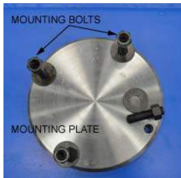
SUGERENCIA: FIGURA 3. DETALLE DE LA PLACA DE MONTAJE
