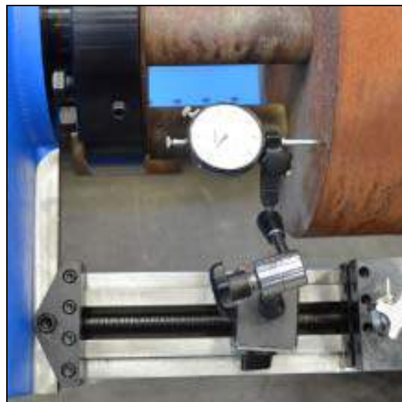
РИСУНОК 8. УСТАНОВКА ИНДИКАТОРА ДЛЯ ВЫРАВНИВАНИЯ СТАНКА
