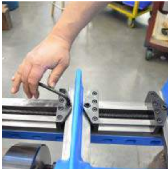
РИСУНОК 9. РАСПОЛОЖЕНИЕ АНКЕРНЫХ БОЛТОВ ТОКАРНОГО ПРУТКА.
