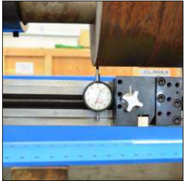
РИСУНОК 7. Установка индикатора для ЦЕНТРИРОВАНИЯ СТАНКА
