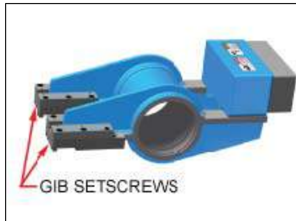
Рисунок 17. Удлинитель для увеличения радиуса обработки в сборе
