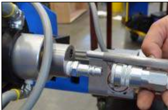
Рисунок 12. Подключение воздушных шлангов
