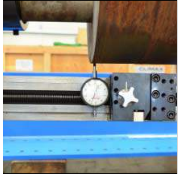
ABBILDUNG 7. POSITIONIEREN EINER ANZEIGE ZUR ZENTRIERUNG DER MASCHINE
