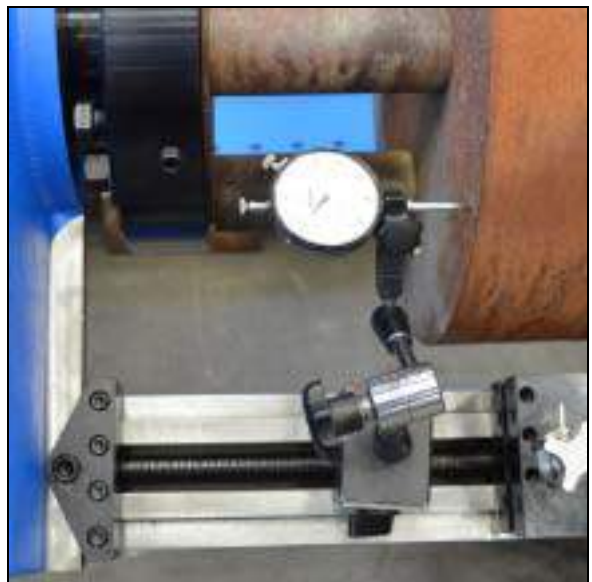
ABBILDUNG 8. POSITIONIEREN EINER ANZEIGE ZUR NIVELLIERUNG DER MASCHINE
