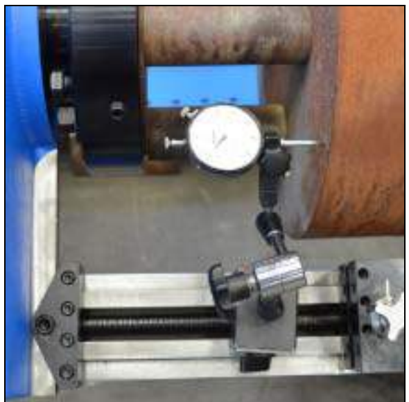
FIGURE 8. POSITIONNEMENT D'UN COMPARATEUR POUR METTRE LA MACHINE DE NIVEAU
