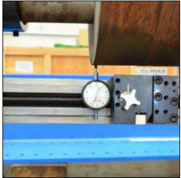
FIGURE 7. POSITIONNEMENT D'UN COMPARATEUR POUR CENTRER LA MACHINE
