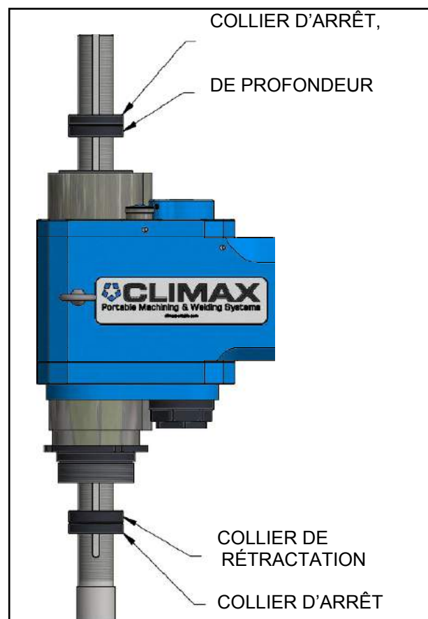
FIGURE 3-2. COLLIERS DE PROFONDEUR ET D'ARRÊT
