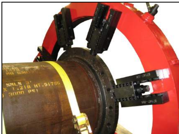
FIGURA 2-1. SOPORTE AMPLIADO INSTALADO
