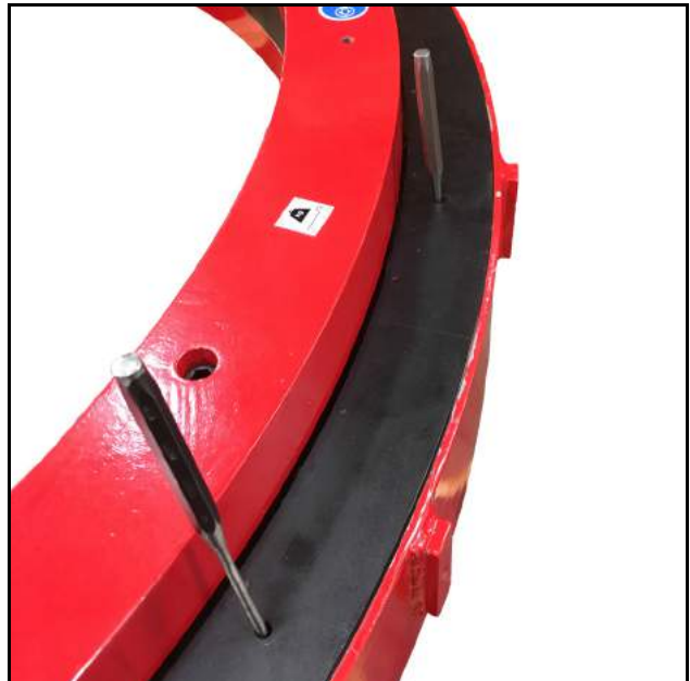
Рисунок 5-2. Пробойники, используемые для установки ограждения
