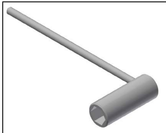
Рисунок 5-3. Ключ для регулировки роликов (№ изделия 86988)
