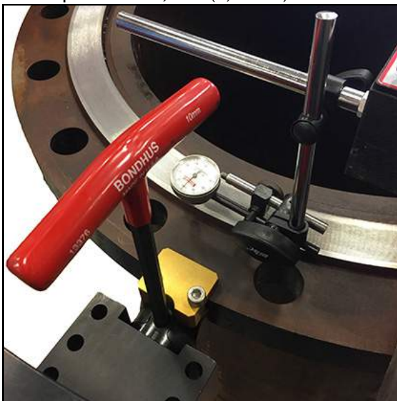
Рисунок 3-7. Цифровой индикатор, установленный для выравнивания
