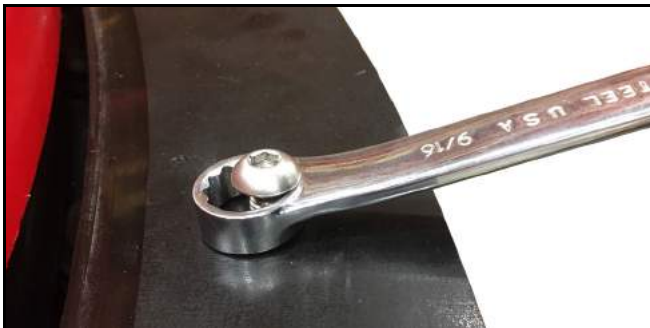
Рисунок 5-1. Накидной гаечный ключ на винте
