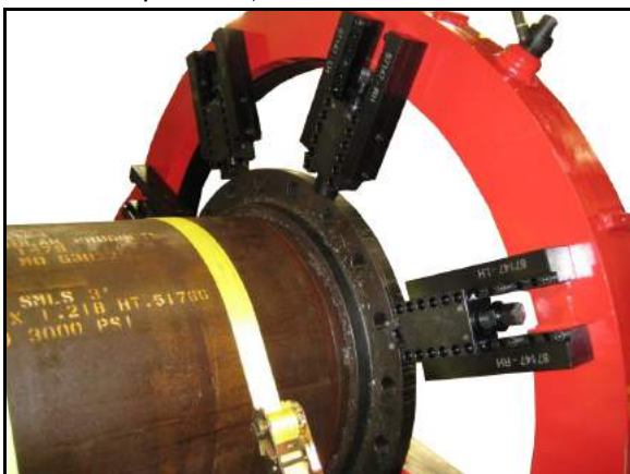
Рисунок 2-1. Установлены удлиненные опоры
