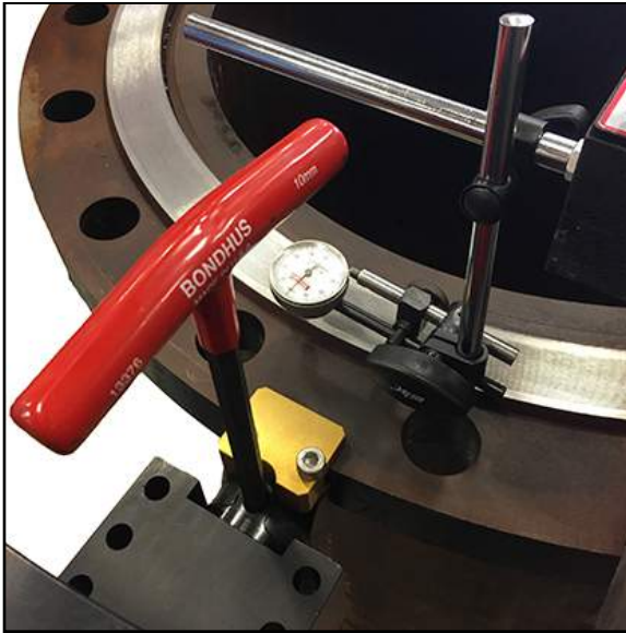
ABBILDUNG 3-7. FEINANZEIGER FÜR DAS NIVELLIEREN
