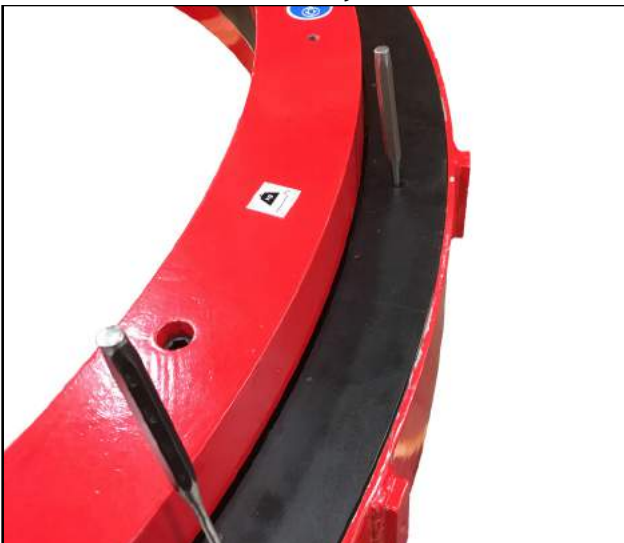
FIGURA 5-2. PUNZONES UTILIZADOS PARA LA INSTALACIÓN DE PROTECCIONES
