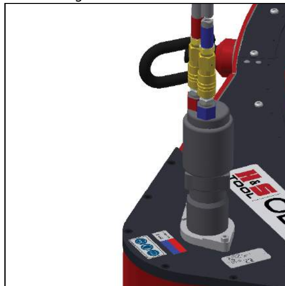
FIGURA 3-11. MOTOR NEUMÁTICO INSTALADO
