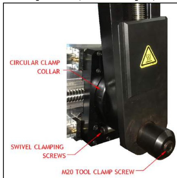
FIGURE 3-8. POSITION DER KLEMMSCHRAUBE FÜR DEN SCHWENKWINKEL
