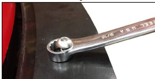
ABBILDUNG 5-1. RINGSCHLÜSSEL HINTER DEM SCHRAUBENKOPF
