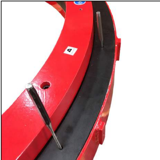
ABBILDUNG 5-2. DORN ALS HILFE BEI DER MONTAGE DER SCHUTZVORRICHTUNG
