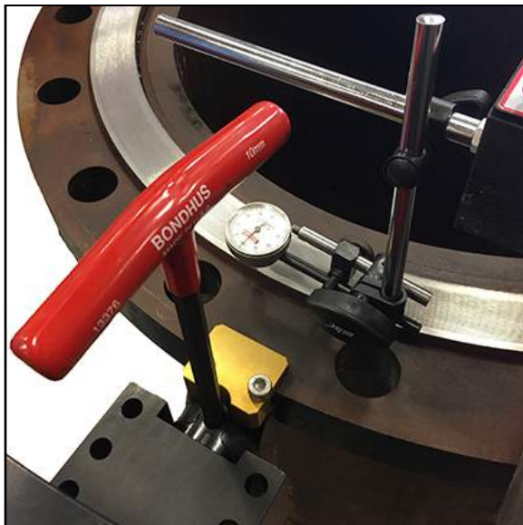
FIGURE 3-7. INDICATEUR À AIGUILLE INSTALLÉ POUR LE NIVELLEMENT
