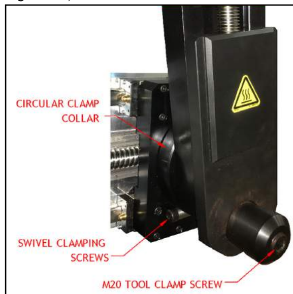
FIGURA 3-8. UBICACIÓN DE LA TUERCA DE SUJECIÓN OSCILANTE
