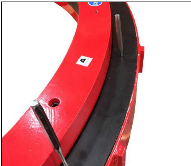
FIGURA 5-2. PUNZONES UTILIZADOS PARA LA INSTALACIÓN DE PROTECCIONES
