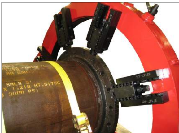
FIGURA 2-1. SOPORTE AMPLIADO INSTALADO
