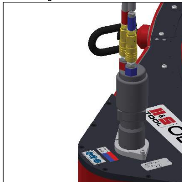
FIGURA 3-11. MOTOR NEUMÁTICO INSTALADO
