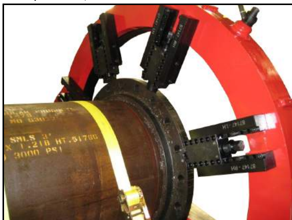
Рисунок 2-1. Установлены удлиненные опоры
