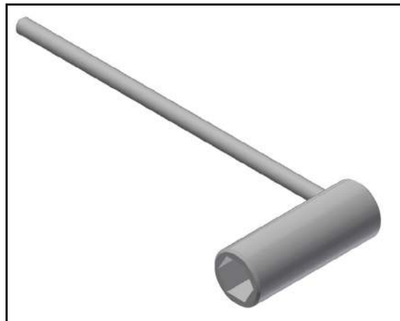
Рисунок 5-3. Ключ для регулировки роликов (№ изделия 86988)
