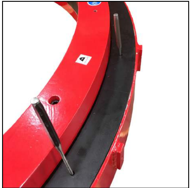
Рисунок 5-2. Пробойники, используемые для установки ограждения
