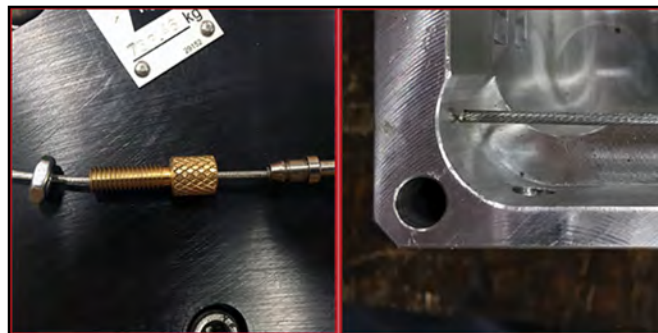
FIGURE 5-10. 90°-ELLBOGEN, EINSTELLMUTTER UND KONTERMUTTER (LINKS); KABELLENDE AN DER TRIMMSTELLE DARGESTELLT (RECHTS)
