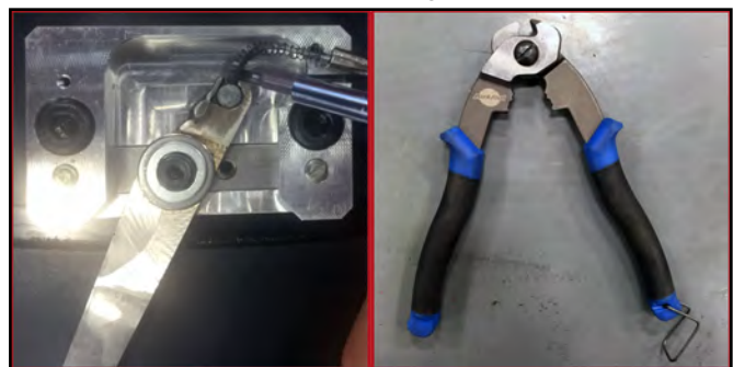
FIGURE 5-8. TROMMELENDE DER KABELENTNAHME (LINKS); KABEL- UND GEHÄUSESCHNEIDER (RECHTS)
