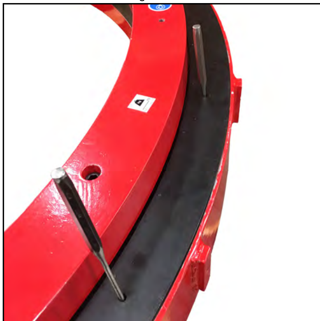
ABBILDUNG 5-3. DORN ALS HILFE BEI DER MONTAGE DER SCHUTZVORRICHTUNG
