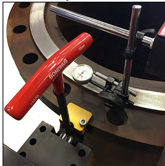
FIGURE 3-8. MESSUHR ZUR NIVELLIERUNG MONTIERT
