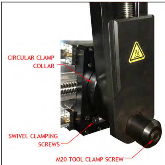
FIGURE 3-9. LAGE DER SCHWENK-KLEMMSCHRAUBE
