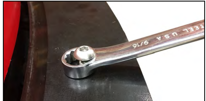
ABBILDUNG 5-2. RINGSCHLÜSSEL HINTER DEM SCHRAUBENKOPF
