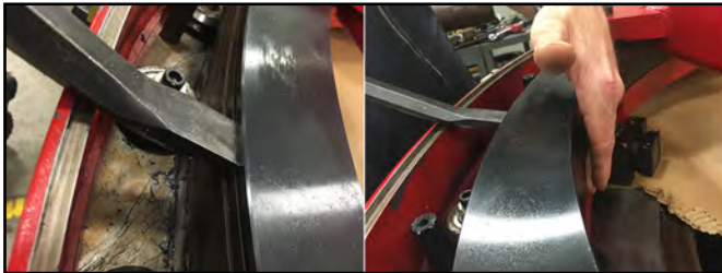
FIGURE 5-6. ÜBERPRÜFUNG DES SPIELS ZWISCHEN DEM LAUFRING UND DEM FESTSTEHENDEN RING
