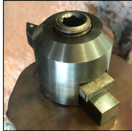
FIGURE 3-10. INSTALLIERTER 0,50"-WERKZEUGADAPTER (P/N 89175)
