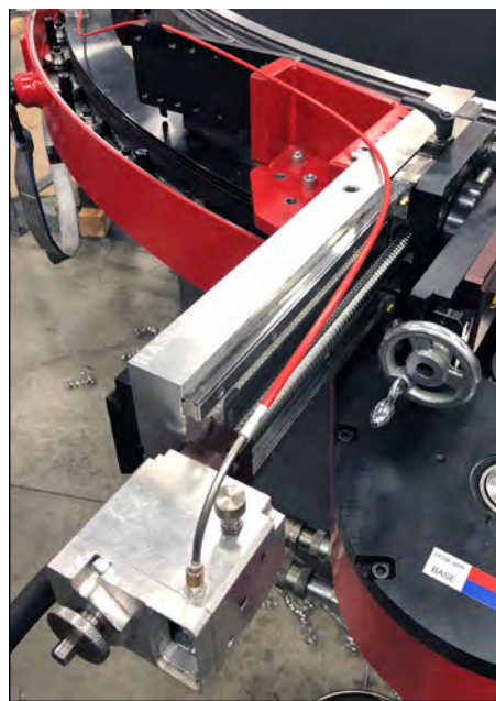
FIGURE 4-4. COMPOSANTS DE FIXATION EN FACE ARRIÈRE REPOSITIONNÉS
