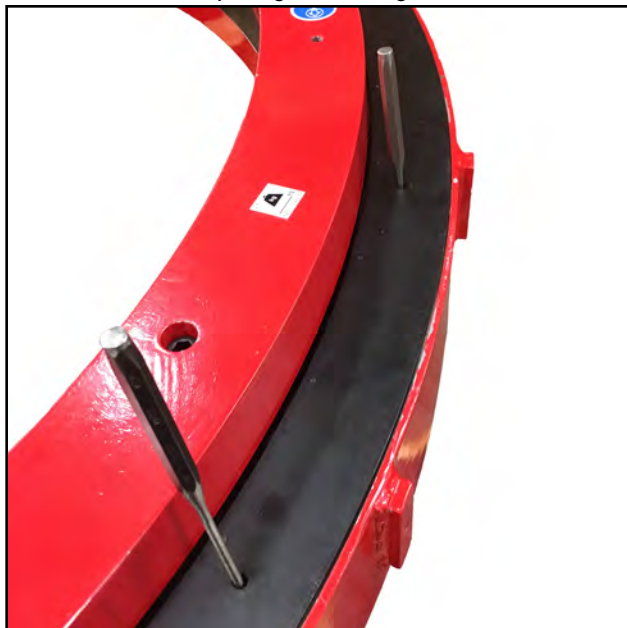
FIGURE 5-3. POINÇONS UTILISÉS POUR L'INSTALLATION DU PROTECTEUR
