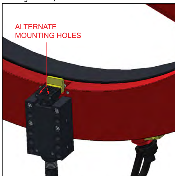
FIGURE 3-4. TROUS DE MONTAGE ALTERNATIFS
