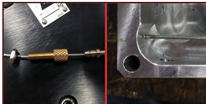
FIGURE 5-10. COUDE À 90°, ÉCROU DE RÉGLAGE ET CONTRE-ÉCROU (GAUCHE) ; EXTRÉMITÉ DE CÂBLE ILLUSTRÉE À L'EMPLACEMENT DE LA COUPE (DROITE)
