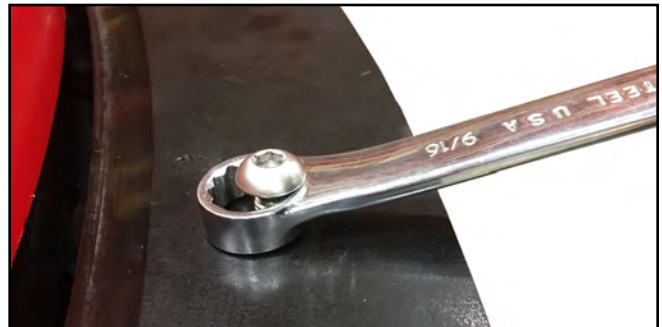
FIGURE 5-2. CLÉ POLYGONALE SUR LA VIS
