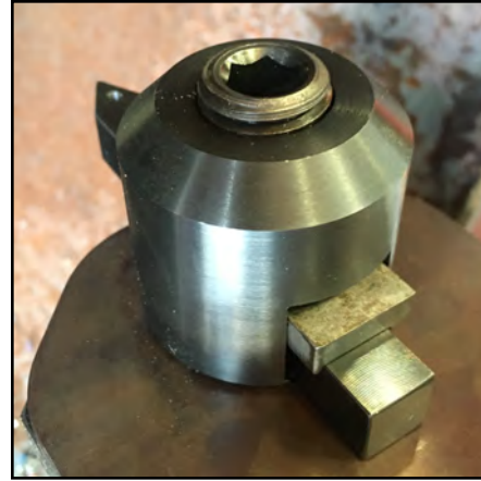
FIGURE 3-10. ADAPTATEUR POUR OUTIL DE 0,50 PO INSTALLÉ (P/N 89175)
