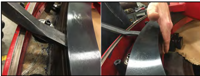
FIGURE 5-6. VÉRIFICATION DU JEU ENTRE LA BAGUE DE PORTÉE ET LA BAGUE FIXE
