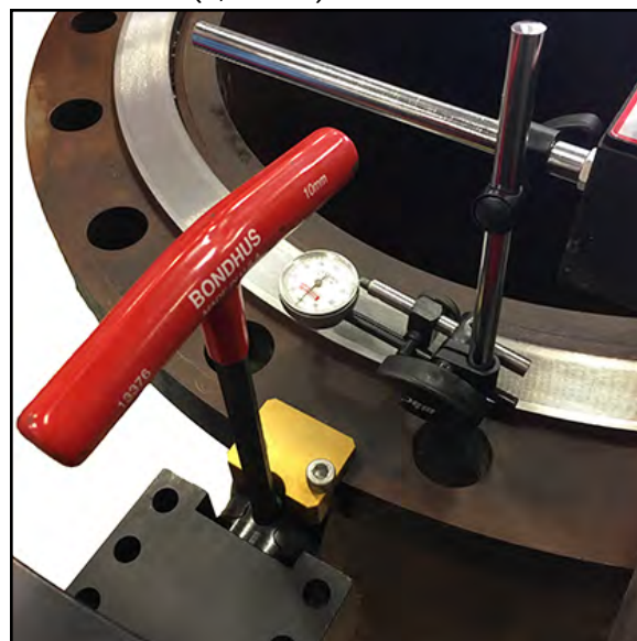
FIGURE 3-8. COMPAREUR À CADRAN INSTALLÉ POUR LE NIVELLEMENT
