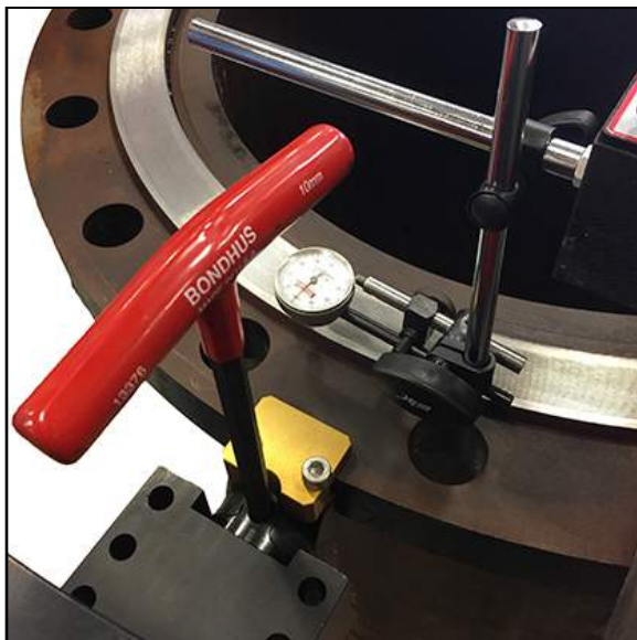
FIGURA 3-7. INDICADOR DE DIAL MONTADO PARA NIVELACIÓN
