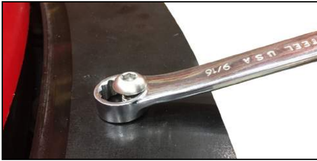
FIGURA 5-1. LLAVE DE ESTRELLA ENCIMA DEL TORNILLO
