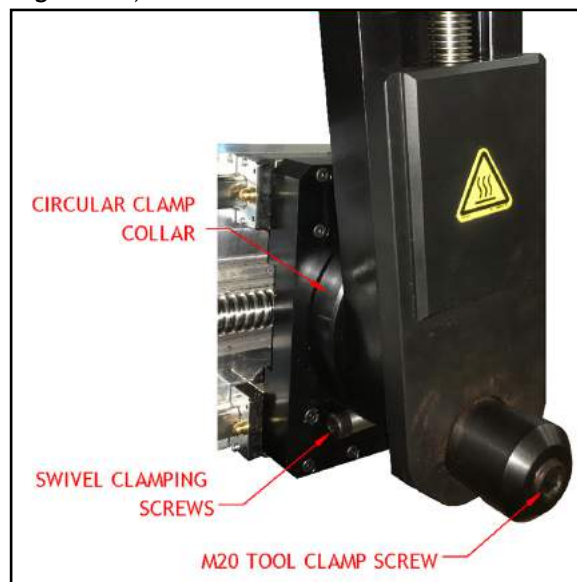
FIGURA 3-8. UBICACIÓN DE LA TUERCA DE SUJECIÓN OSCILANTE
