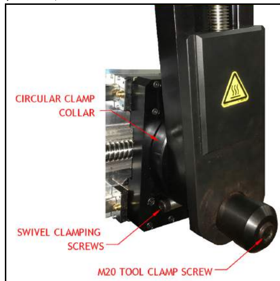
РИСУНОК 3-8. МЕСТОНАХОЖДЕНИЕ ВИНТА ФИКСАЦИИ НАКЛОНА
