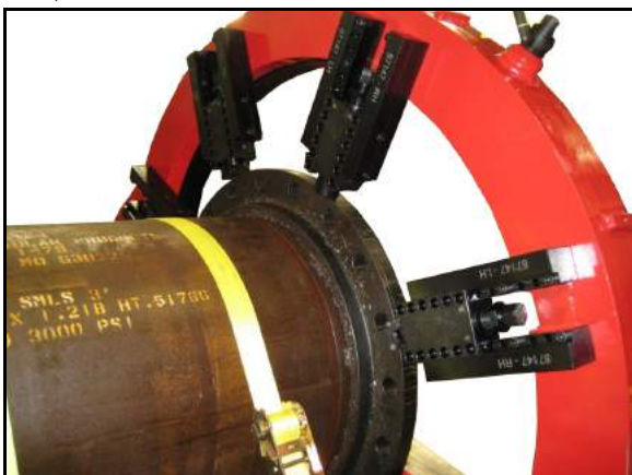
Рисунок 2-1. Установлены удлиненные опоры
