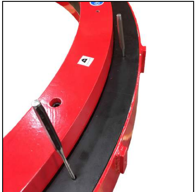
Рисунок 5-2. Пробойники, используемые для установки ограждения
