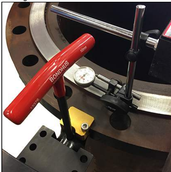
ABBILDUNG 3-7. FEINANZEIGER FÜR DAS NIVELLIEREN
