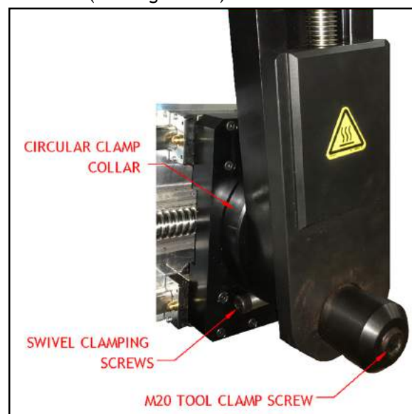
FIGURE 3-8. EMPLACEMENT DE LA VIS DE SERRAGE OSCILLANTE
