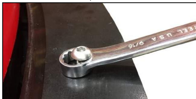
FIGURE 5-1. CLÉ POLYGONALE SUR LA VIS
