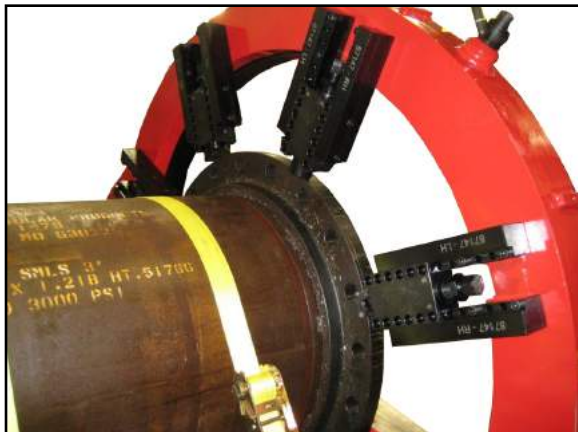
FIGURE 2-1. PIEDS D'EXTENSION MIS EN PLACE
