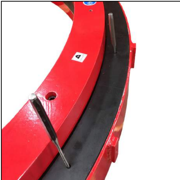
FIGURE 5-2. POINÇONS UTILISÉS POUR L'INSTALLATION DU PROTECTEUR
