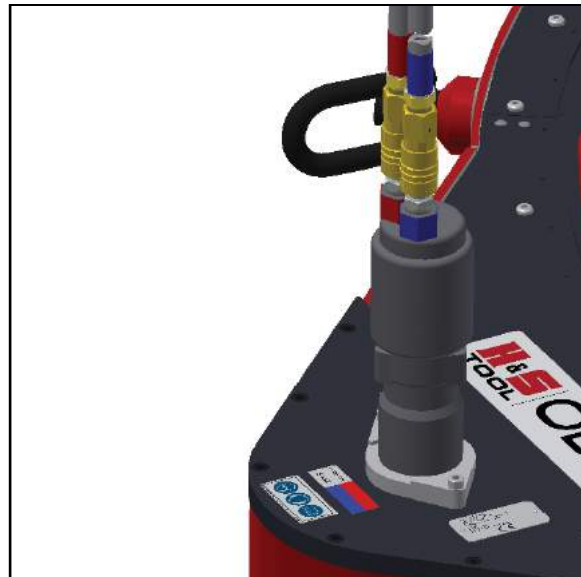
FIGURE 3-11. MOTEUR D'ENTRAÎNEMENT PNEUMATIQUE INSTALLÉ
