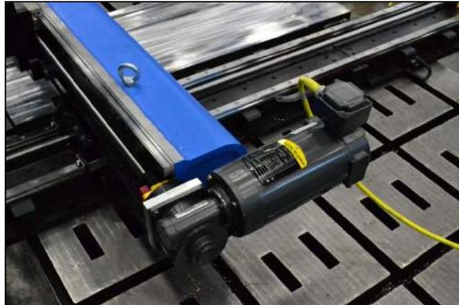
Двигатель, закрепленный на шариковом винте на салазках
