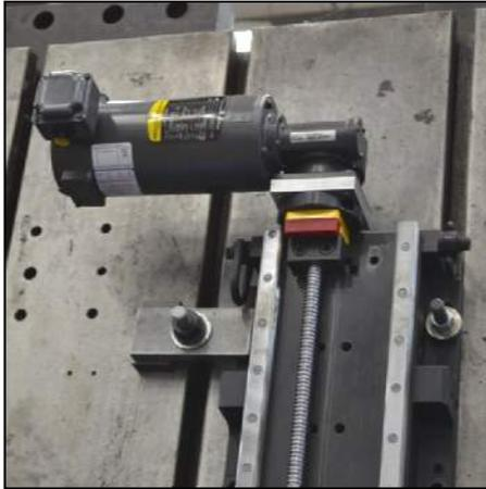
Двигатель, закрепленный на шариковом винте на платформе
