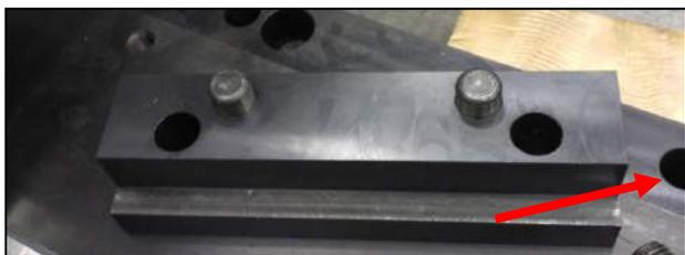
Нижние поверхности инструментов для выравнивания платформы отшлифованы.
