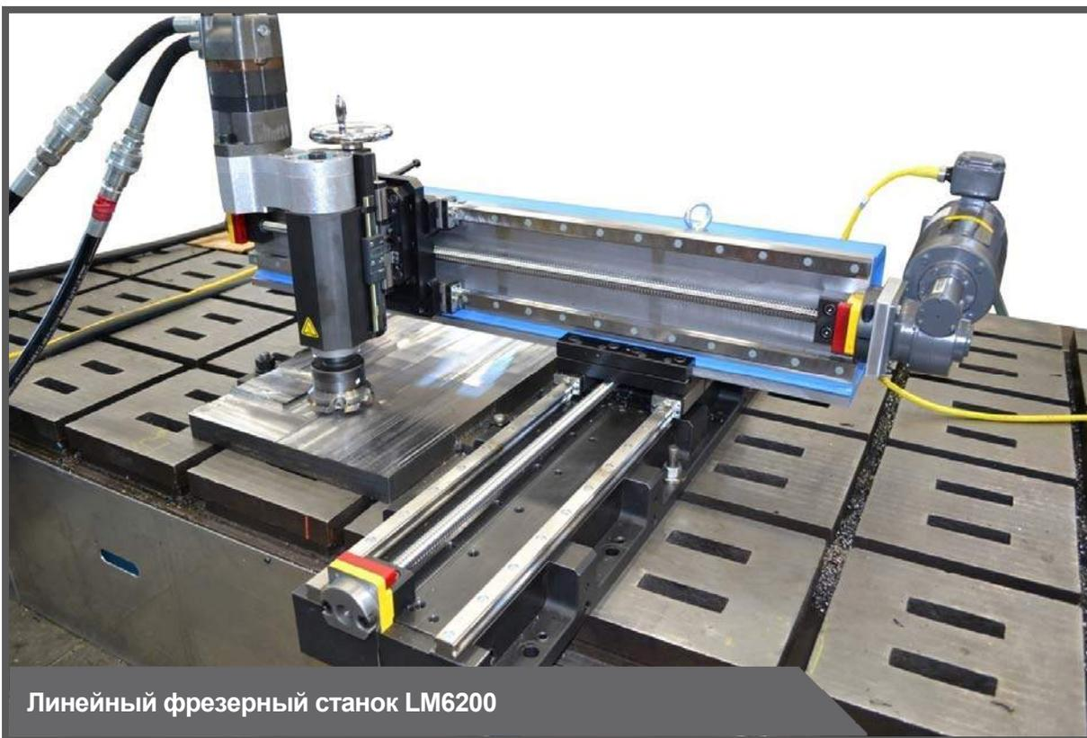
Линейный фрезерный станок LM6200
