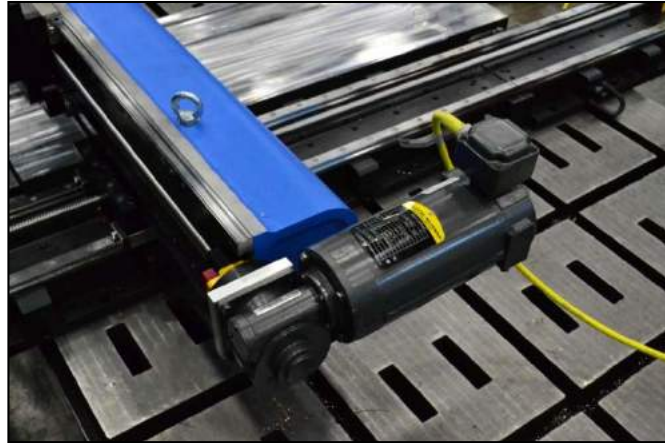
Moteur fixé à la vis à bille sur coulisseau
