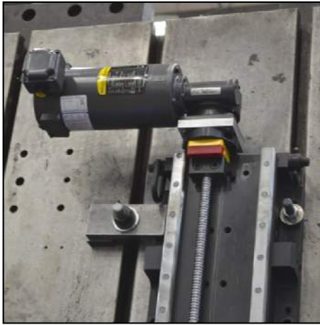
Moteur fixé à la vis à bille sur le banc
