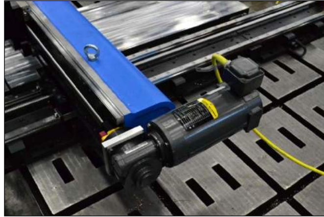
Motor unido al husillo de bolas en el cilindro
