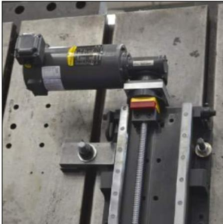
Am Kugelgewindtrieb auf dem Ständer befestigter Motor
