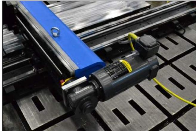
Am Kugelgewindtrieb auf dem Querbalken befestigter Motor
