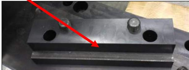
Die Oberfläche von Ständerausrichtwerkzeugen ist geschliffen.
